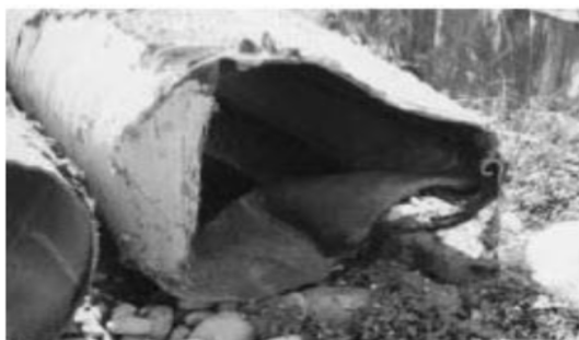
شکل (۳-۱): زلزله ۱۹۹۹ چی چی تایوان و تغییر شکل بزرگ سطح مقطع لوله (۶۰)
