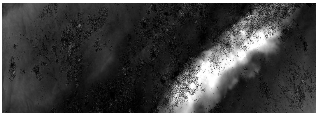
شکل ۴-۱۷: تصحیح مقادیر فاز بر روی زوج تصویر S3 از ماهواره Sentinel-1
