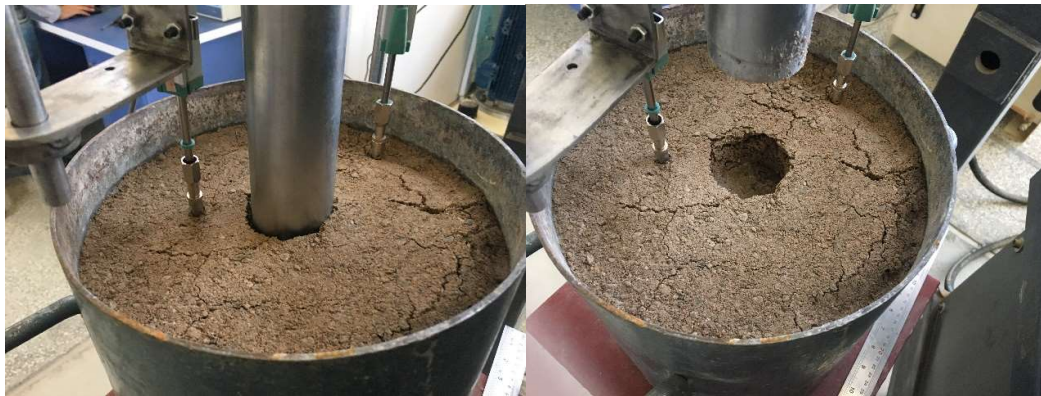
شکل (۳-۶) مراحل بارگذاری استاتیکی و محل قرارگیری LVDT
