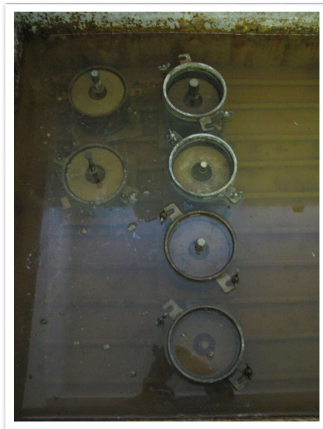
شکل (۳-۵) فرآیند اشباع سازی نمونه ها جهت آزمایش CBR
