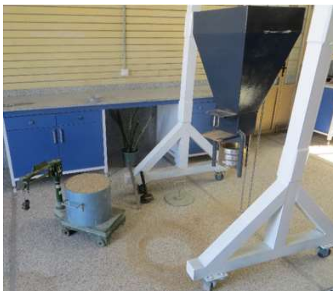
شکل ۴-۳ ( تصویر وسایل استفاده شده برای آزمایش تعیین حداقل و حداکثر وزن مخصوص ماسه
