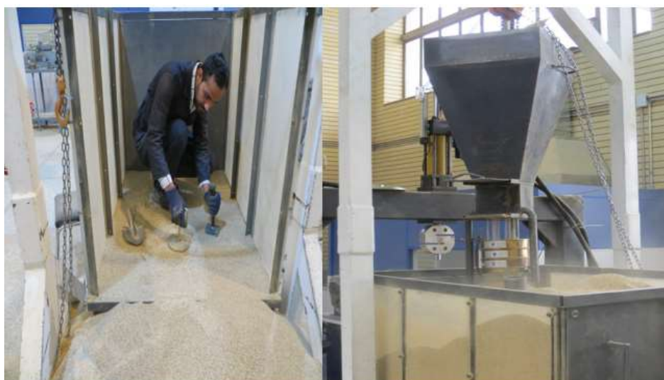
شکل ۱۵-۳) آماده سازی نمونه های خاک در دو تراکم نسبی ۳۰ درصد (بارش ماسه) و ۹۰ درصد (متراکم سازی)
