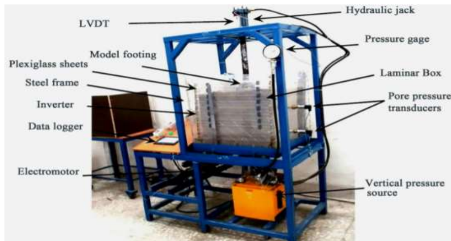
شکل ۱۷-۲ (نمای کلی جعبه‌ی برش شفاف [۲۲])
