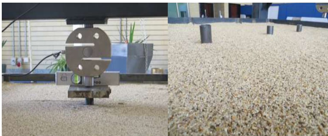
شکل (۱۱-۳) وضعیت نمونه‌های میکروپایل و خاک پیش از اعمال بارگذاری استاتیکی
