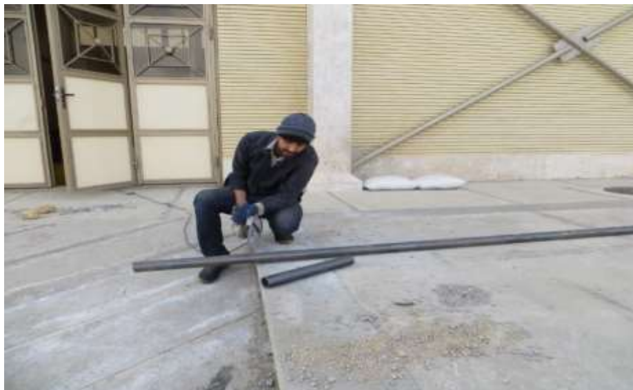
شکل ۳-۶) ایجاد نمونه‌های میکروپایل در طول‌های مد نظر
