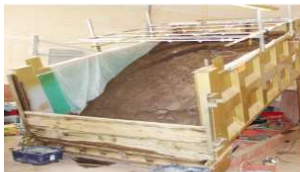
شکل (۱۳-۲) مدل فیزیکی شیروانی برای تثبیت با میکروپایل [۱]
