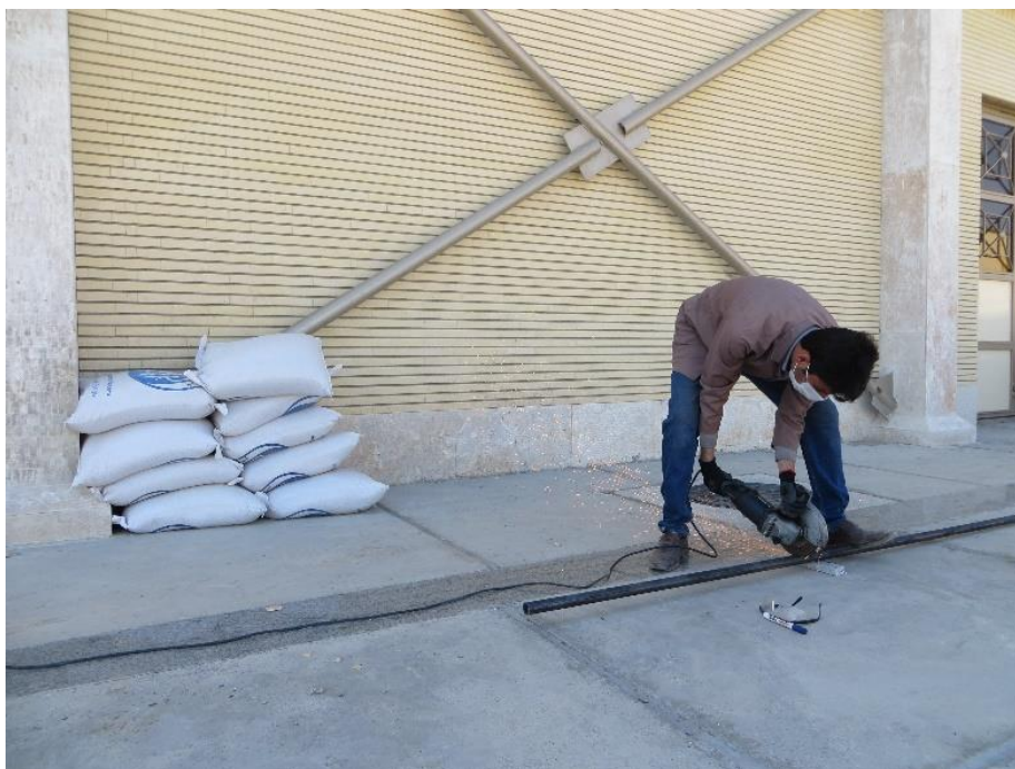
شکل (۳-۶) ایجاد نمونه‌های میکروپایل در طول‌های مد نظر
