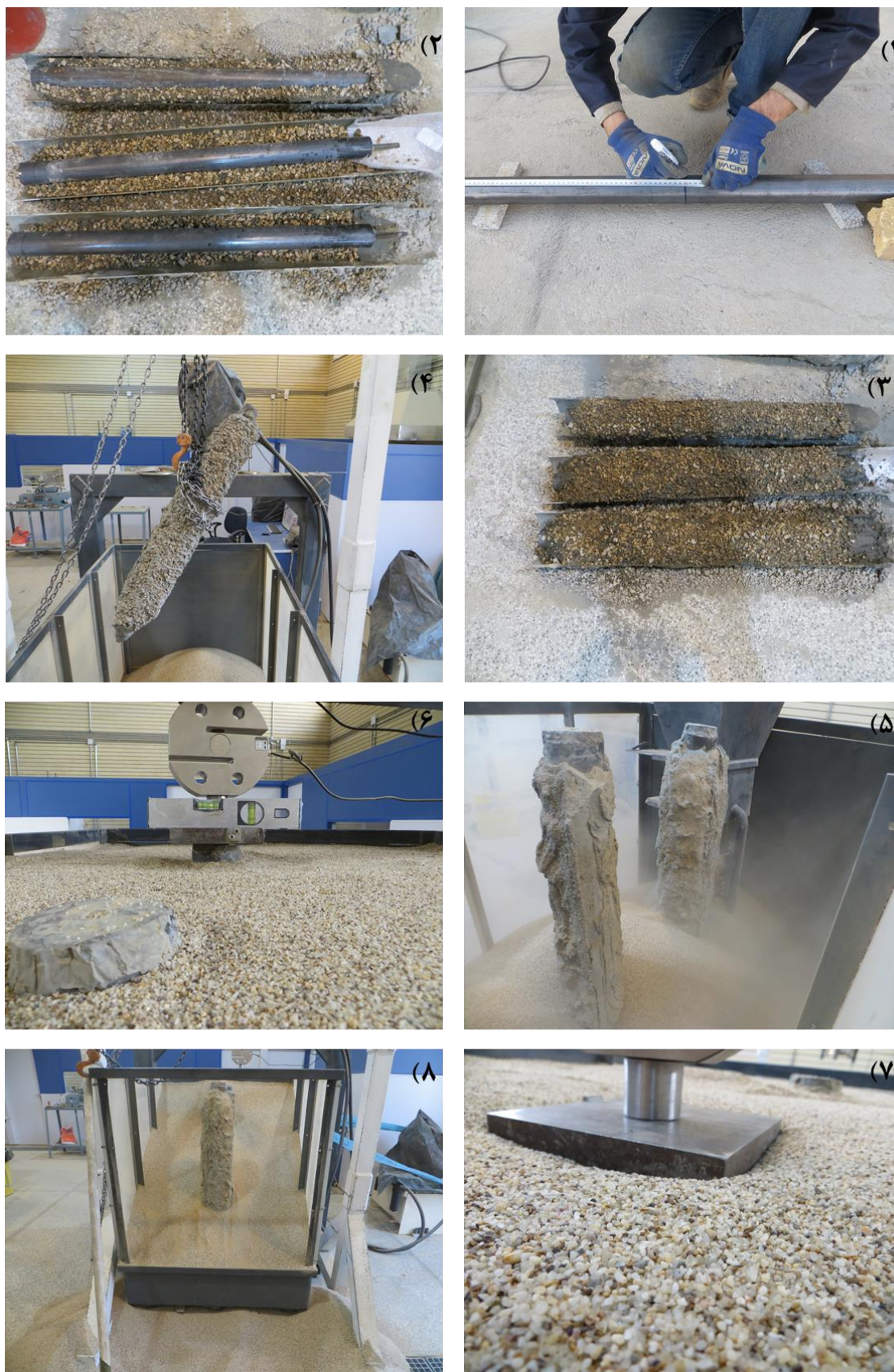
شکل (۳-۱۸) نمونه سازی جهت انجام آزمایش در تراکم نسبی ۴۵ درصد
