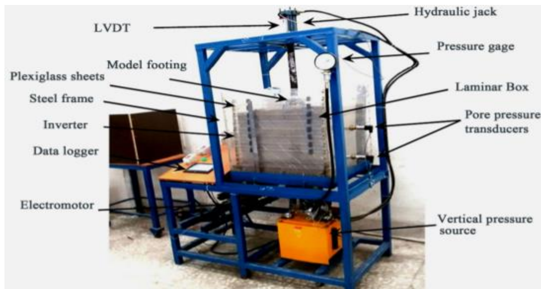
شکل (۲-۲۸) نمای کلی جعبه‌ی برش شفاف [۳۷]
