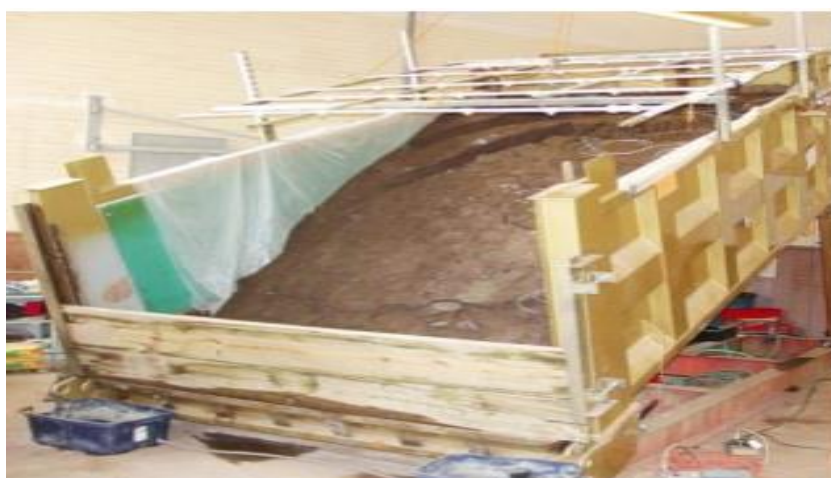
شکل (۲-۱۸) مدل فیزیکی شیروانی برای تثبیت با میکروپایل [۳]
