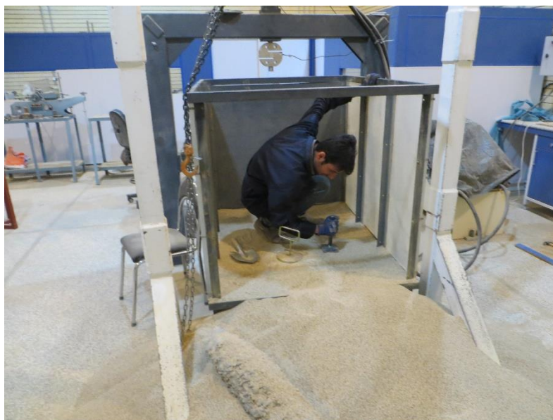
شکل (۱۹-۳) نمونه سازی جهت انجام آزمایش در تراکم نسبی ۹۰ درصد
