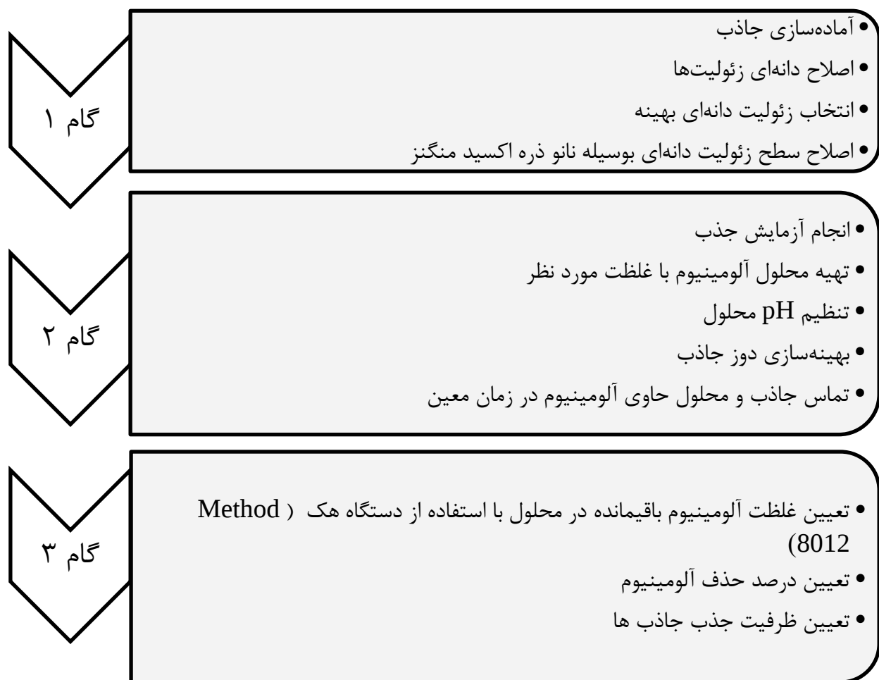
شکل ۳-۷- روند کلی آزمایش‌های حذف آلومینیوم
