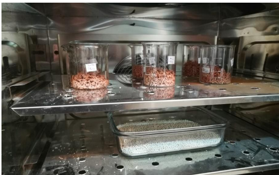
شکل ۳-۳- نمونه زئولیت‌های دانه‌ای خشک‌شده در آون با دمای ۱۰۵ درجه سانتی‌گراد به مدت ۱۲ ساعت
