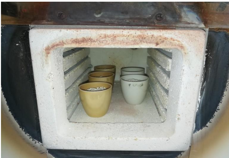
شکل ۳-۲- زئولیت‌های دانه‌ای قرار داده شده در کوره در ۳ دمای مختلف
