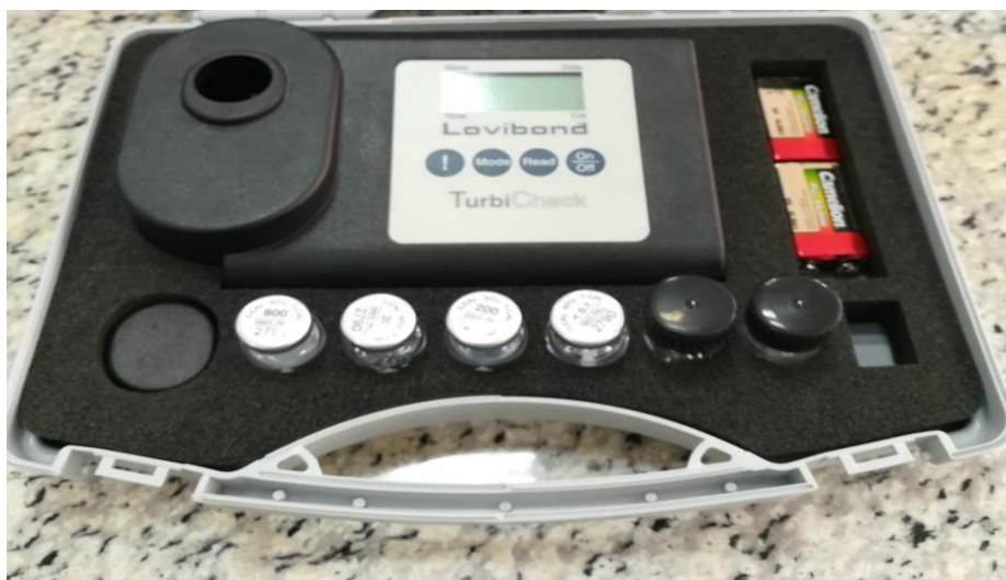
شکل ۳-۶- کدورت‌سنج استفاده شده در این تحقیق به منظور اندازه‌گیری کدورت محلول
