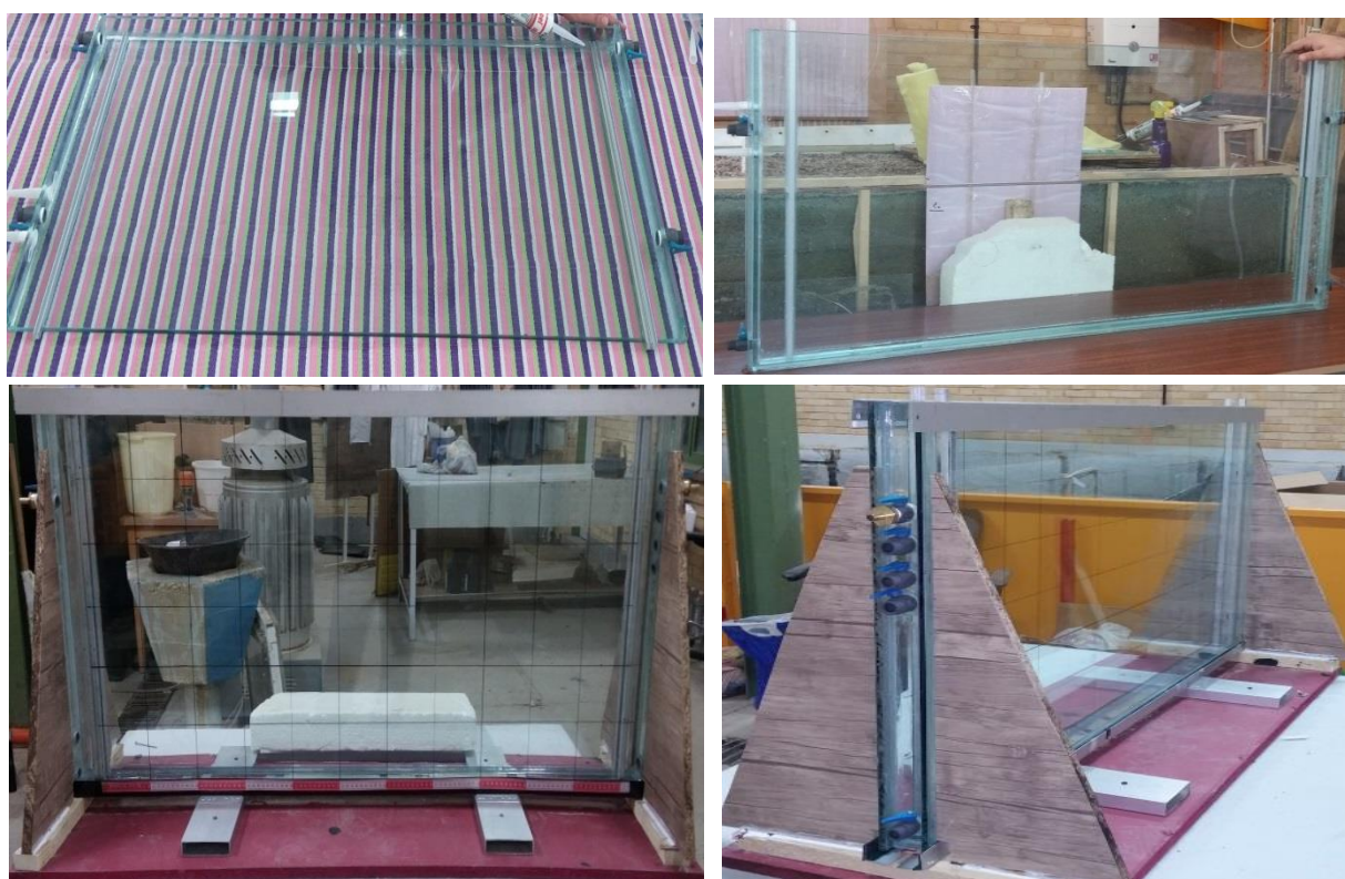
شکل ۱-۳ تصاویری از روند ساخت فلوم آزمایشگاهی (مخزن جریان) در آزمایشگاه.
