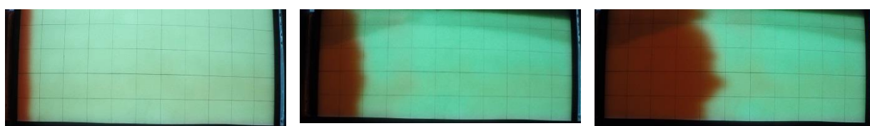
شکل ۳-۵ پیشروی آب شیرین قرمز رنگ درون محیط متخلخل جهت اندازه‌گیری هدایت هیدرولیکی
