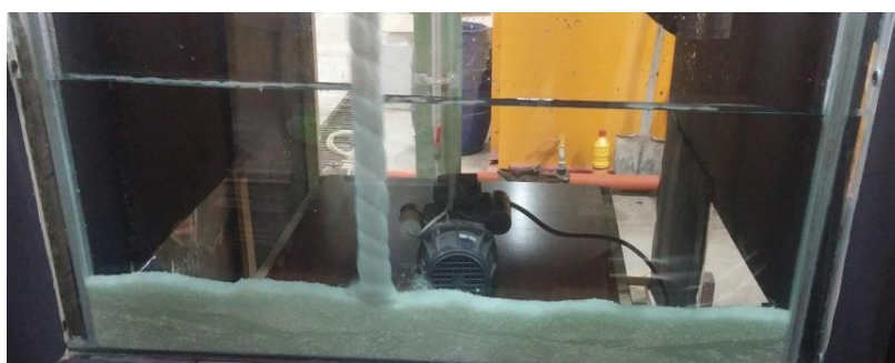
شکل ۳-۷ تصویر دیجیتال از نحوه متراکم کردن دانه‌های شیشه‌ای درون محفظه مرکزی
