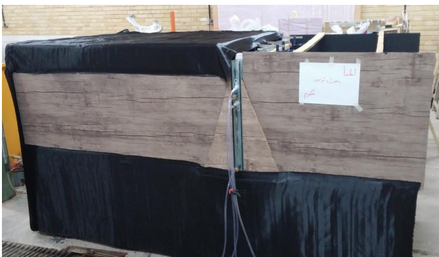
شکل ۳-۳ تصویر اتاقک تاریک ساخته‌شده در آزمایشگاه، فلوم ماسه‌ای درون اتاقک قرار گرفته است.
