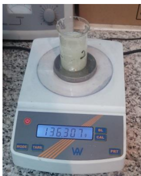
شکل ۳-۴ تصاویری از روند اندازه‌گیری تخلخل دانه‌های شیشه‌ای در آزمایشگاه
