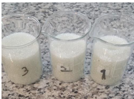
شکل ۳-۴ تصاویری از روند اندازه‌گیری تخلخل دانه‌های شیشه‌ای در آزمایشگاه
