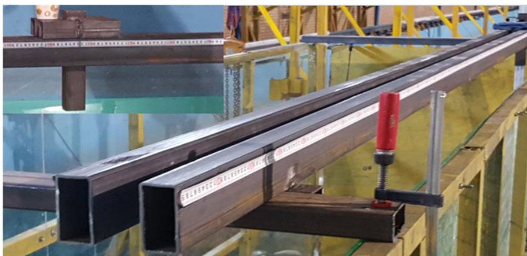
شکل (۳-۲۶) : تجهیزات اندازه گیری و برداشت نیم رخ مدل فیزیکی
