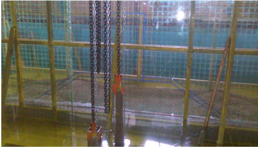
شکل (۳-۲۱): نمایی از صفحه پلکسی گلس شفاف مدرج با دقت سانتی متر و محل اجرای مدل آزمایشگاهی موج شکن
