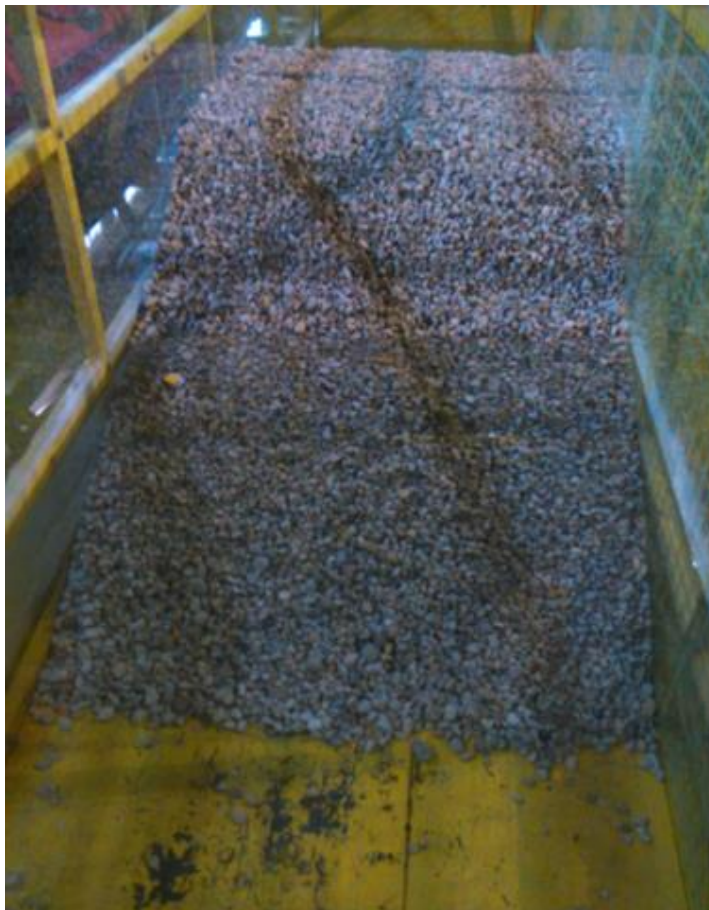
شکل (۳-۲۲): نمایی از اجرای مصالح مغزه در مدل سازی آزمایشگاهی
