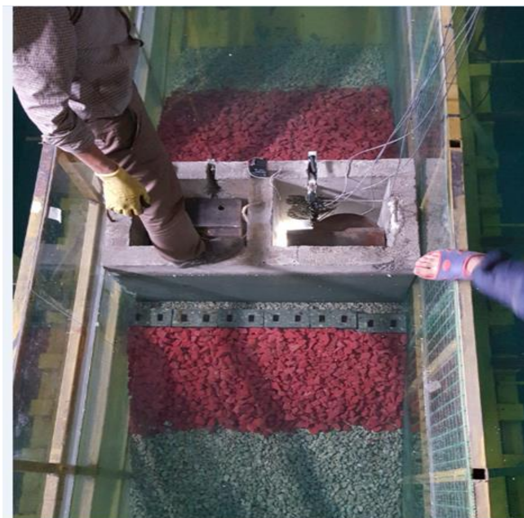
شکل (۲۳-۳): جای گذاری کیسون بر روی زیرسازه سنگی و ریختن مصالح فیلتر
