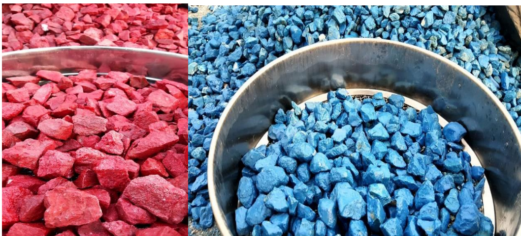
شکل (۳-۱۹) : نمایی از سنگدانه های رنگ شده فیلتر و آرمور به ترتیب آبی و قرمز
