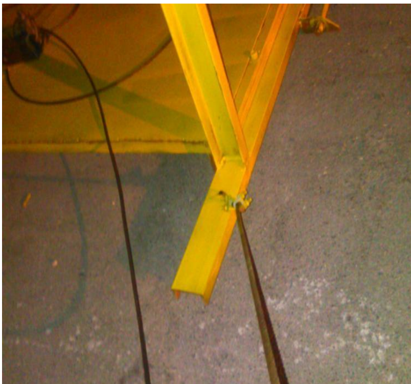
شکل (۳-۹) : نحوه اتصال کابل به انتهای فلوم ثانویه
