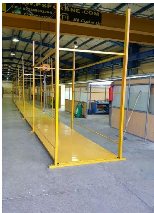
شکل (۳-۸) : نمایی از ساخت و چینش فلوم ثانویه در کارگاه جوشکاری آزمایشگاه
