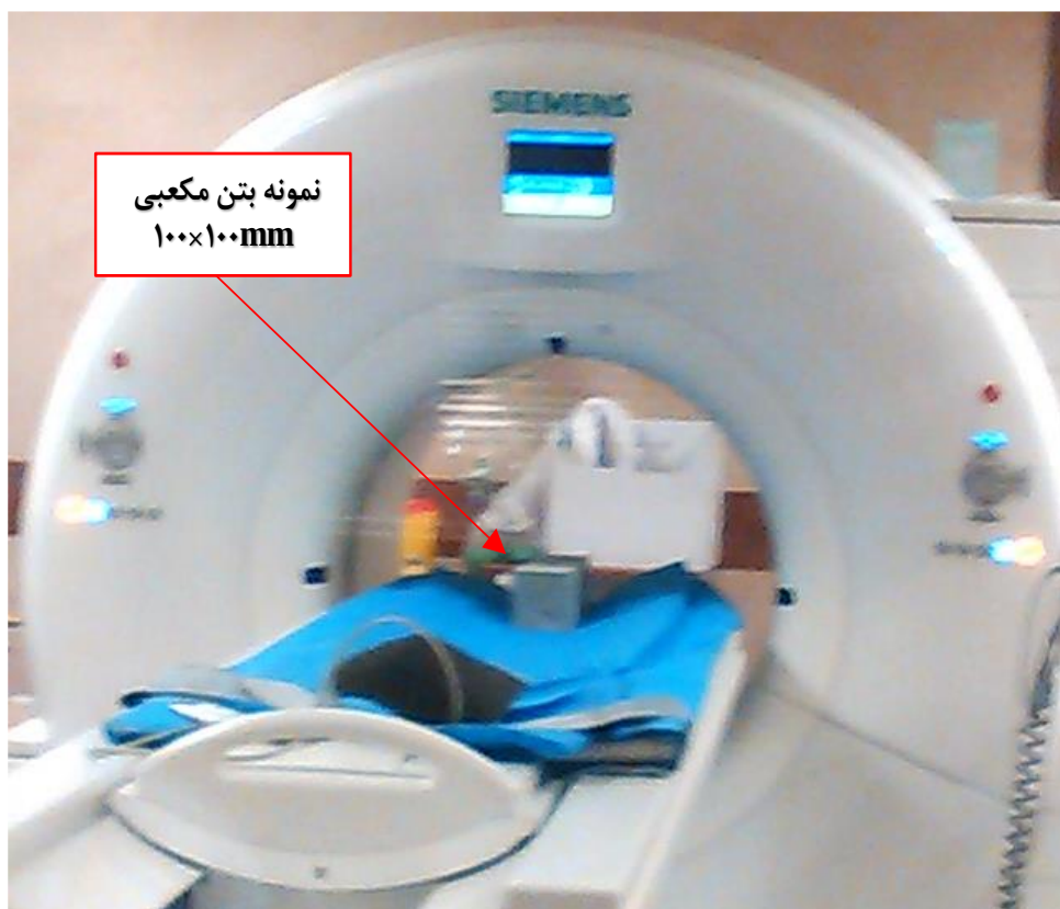
شکل (۵-۲) نمونه بتن مکعبی نوع اول در دستگاه سی تی اسکن بیمارستان قلب شهید رجایی تهران
