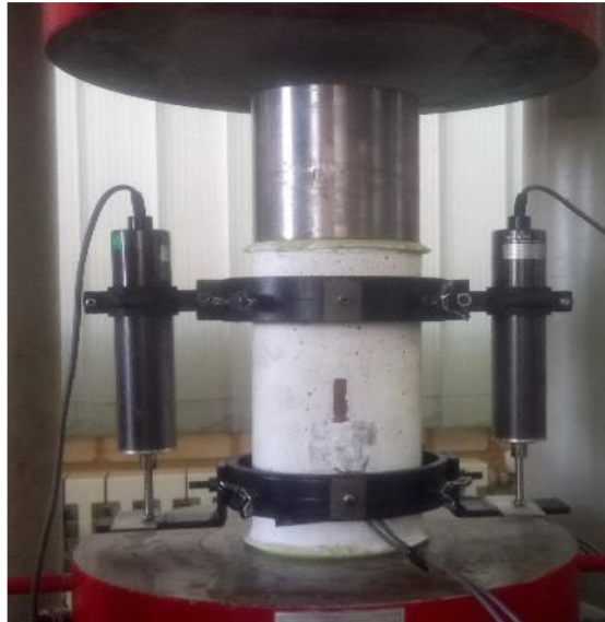
شکل (۳-۲۵) نمونه ملات همراه با دو LVDT و دو کرنش‌سنج تحت فشار با دستگاه جک یونیورسال ۳۰۰ تن
