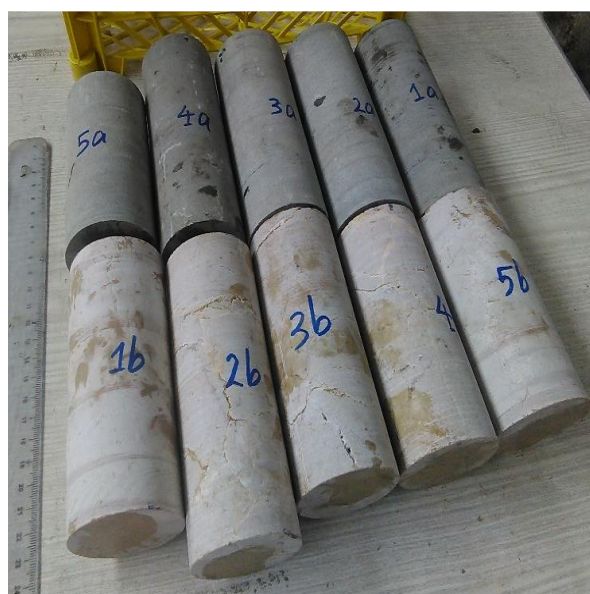
شکل (۳-۱۷) نمونه‌های مغزه‌ی سنگ‌ها پس از برش دو سر آنها
