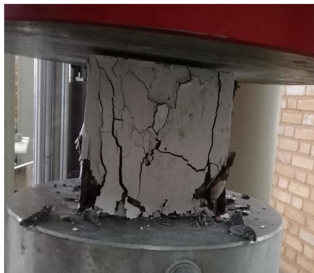
شکل (۳-۴۶) نمایی از پیشرفت ترک در یک وجه نمونه مکعبی نوع دوم (اسکن شده)
