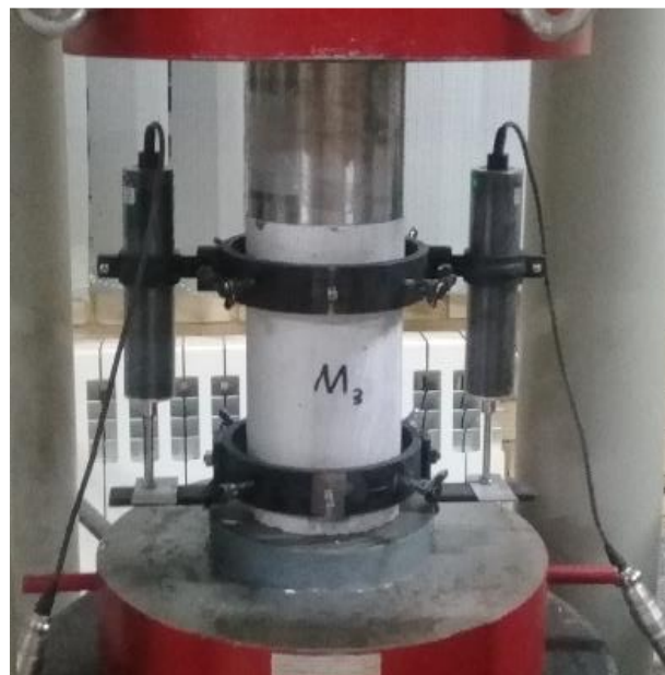
شکل (۳-۳۰) آزمایش فشاری جهت تعیین منحنی تنش - کرنش و مدول الاستیسیته برای ملات نوع دوم
