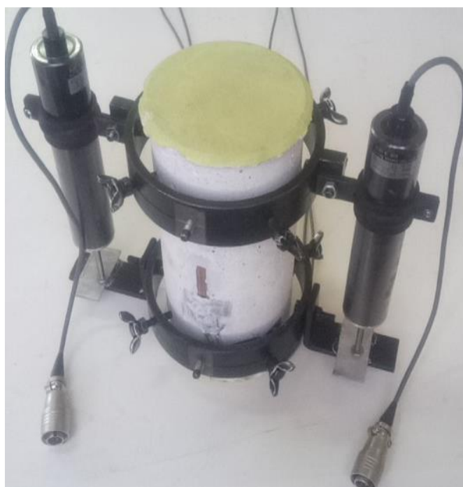
شکل (۳-۲۰) ستاپ LVDT و حلقه‌ها بر روی نمونه ملات ۱۰۰×۲۰۰ mm مطابق با استاندارد ASTM C ۴۶۹-۰۲
