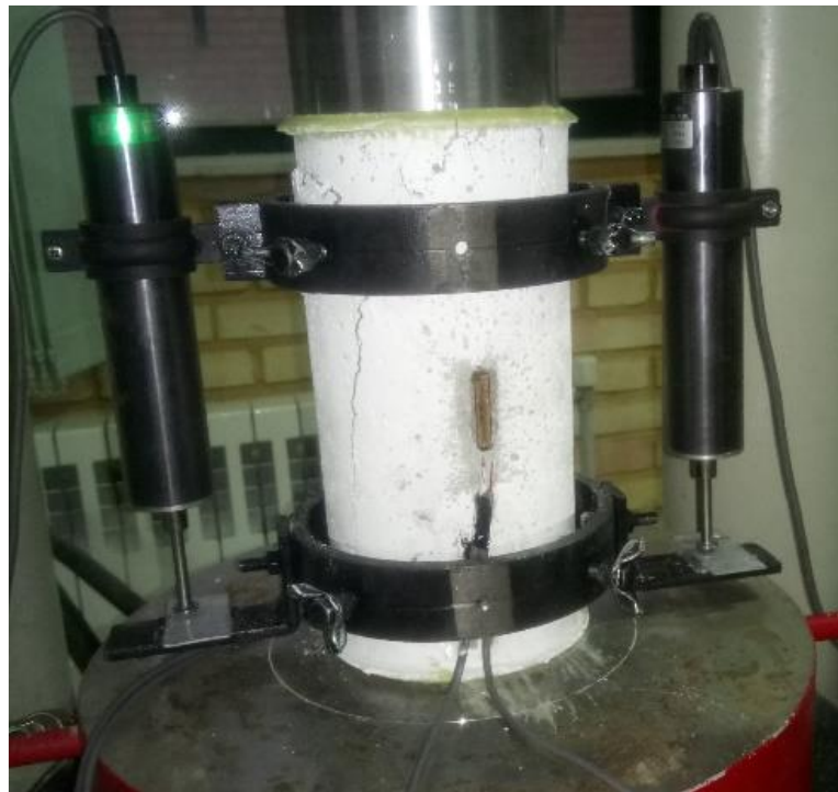
شکل (۳-۲۸) نمونه ملات ماسه سیمان شکسته شده با دستگاه جک یونیورسال ۳۰۰ تن
