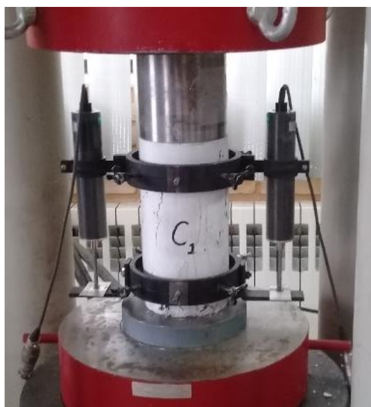
شکل (۳-۴۸) نمونه بتن استوانه‌ای به ابعاد 100 \times 200 mm تحت آزمایش فشاری جهت تعیین منحنی تنش - کرنش و مدول الاستیسیته دقیق بتن
