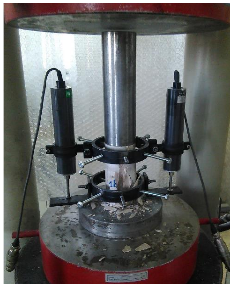
شکل (۳-۳۵) نمونه مغزه سنگ آهک (1b) پس از شکست تحت فشار
