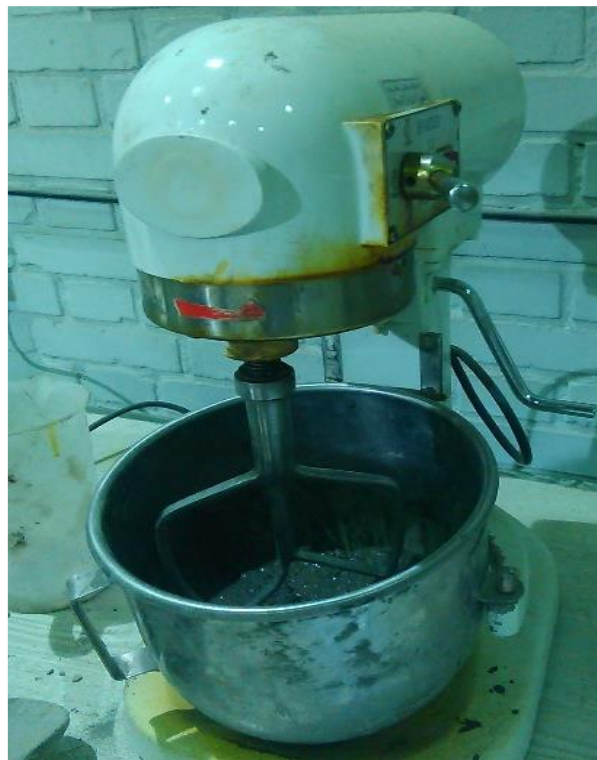
شکل (۳-۹) ساخت ملات مطابق با استاندارد ASTM C ۳۰۵
