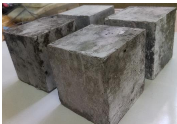
شکل (۳-۶) نمونه‌های مکعبی ۲۸ روزه بتن سری اول، با نسبت آب به سیمان ۰/۳۵
