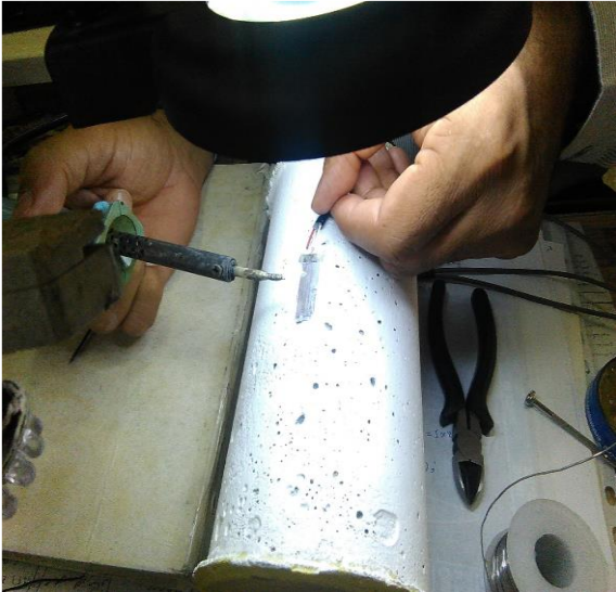
شکل (۳-۲۳) کرنش سنج با مشخصه PFL-20-11 و اتصال پایه‌های آن به سیم دیتا با لحیم کاری
