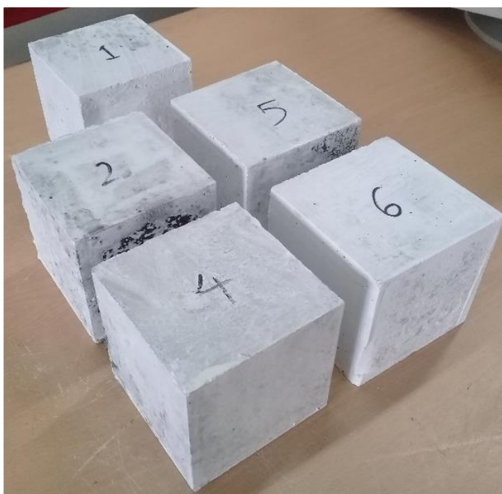
شکل (۳-۷) نمونه‌های مکعبی بتن سری دوم به ابعاد 100 \times 100 \text{ mm} با نسبت آب به سیمان ۰/۳۱
