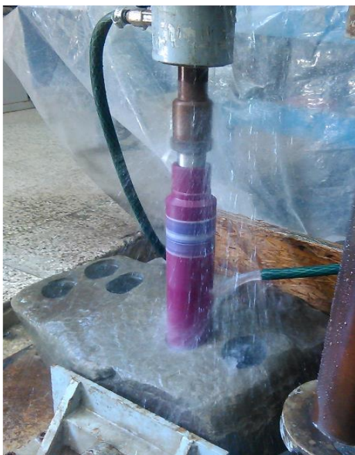
شکل (۳-۱۴) تهیه تعداد ۵ مغزه از دو نمونه سنگ مادر با استفاده از دستگاه مغزه گیر در آزمایشگاه مکانیک سنگ
