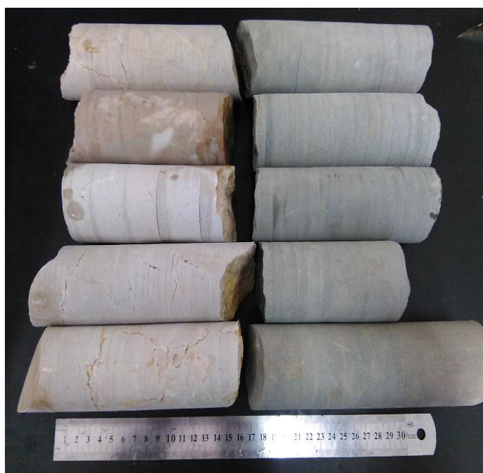
شکل (۳-۱۵) مغزه‌های به دست آمده (سمت راست ماسه سنگ و سمت چپ سنگ آهک)
