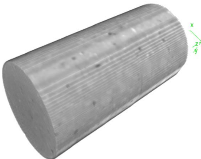
شکل (۵-۱۲) مدل سه بعدی حاصل از برهم‌نهی برش‌های تصویر سی تی اسکن (100×100×200Pixels)
