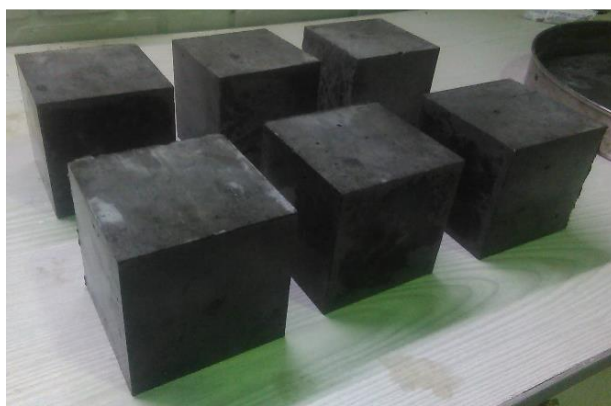
شکل (۳-۶) نمونه‌های مکعبی ۲۸ روزه بتن سری اول، با نسبت آب به سیمان ۰/۳۵
