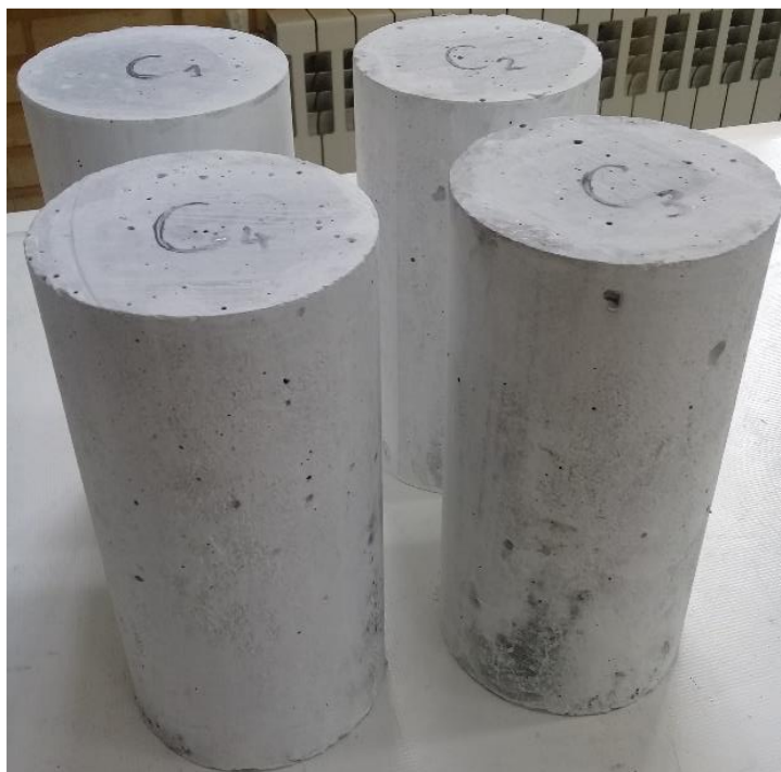
شکل (۳-۸) نمونه‌های استوانه‌ای بتن به ابعاد 100 \times 200 \text{ mm} با نسبت آب به سیمان ۰/۳۱
