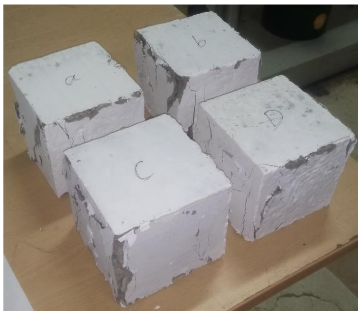
شکل (۴۳-۳) نمونه‌های مکعبی نوع اول با نسبت آب به سیمان ۰/۳۵ پس از شکست
