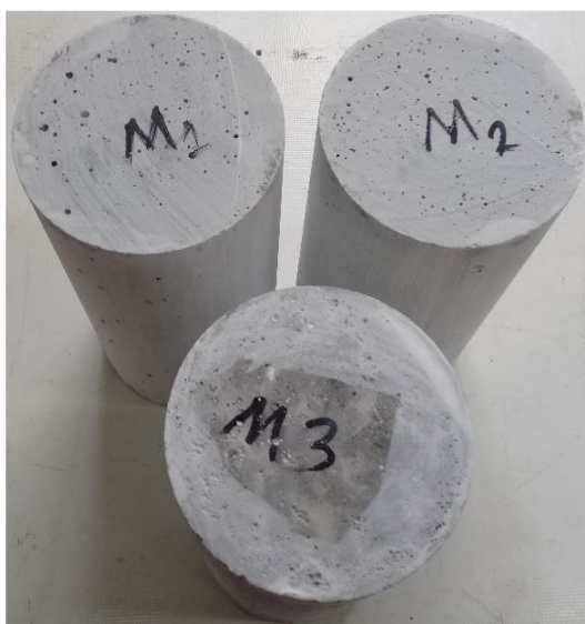
شکل (۱۱-۳) نمونه‌های ملات استوانه‌ای سری دوم (نسبت آب به سیمان برابر ۰/۳۱)
