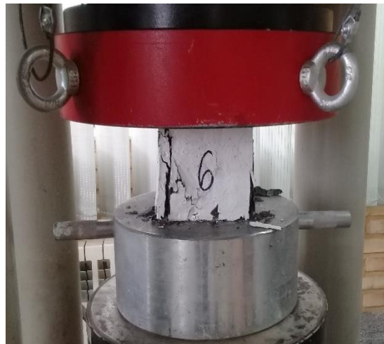
شکل (۳-۴۵) شکست نمونه مکعبی (سی تی اسکن شده) با جک یونیورسال ۳۰۰ تن
