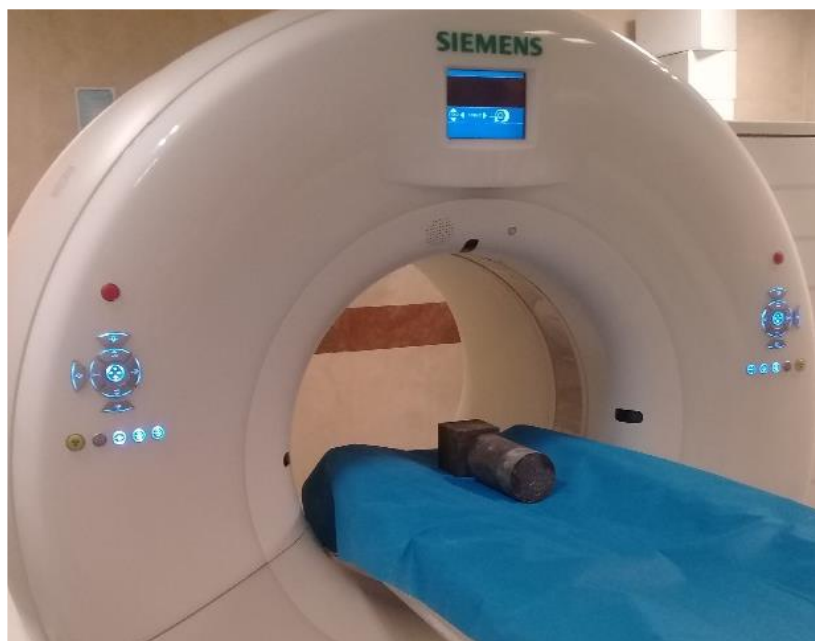
شکل (۵-۳) نمونه بتن مکعبی سری دوم و نمونه استوانه‌ای در دستگاه سی تی اسکن بیمارستان قلب شهید رجایی
