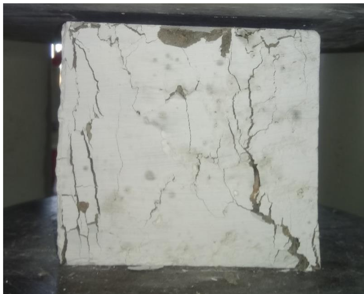
شکل (۴۲-۳) شکست نمونه مکعبی نوع اول زیر جک یونیورسال ۳۰۰ تن
