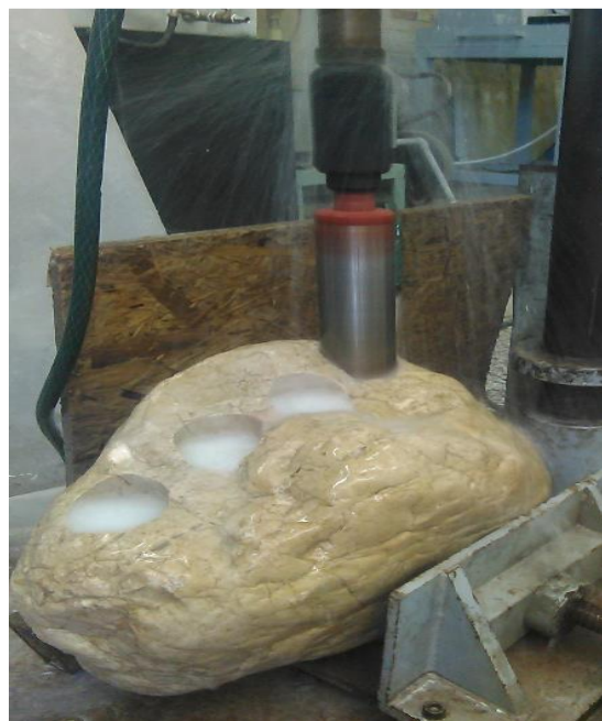
شکل (۳-۱۴) تهیه تعداد ۵ مغزه از دو نمونه سنگ مادر با استفاده از دستگاه مغزه گیر در آزمایشگاه مکانیک سنگ
