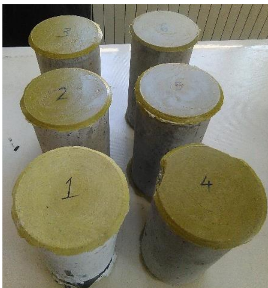
شکل (۱۰-۳) نمونه‌های ملات استوانه‌ای 100 \times 200 \text{ mm} سری اول کپینگ شده ( w/c=0.35 )
