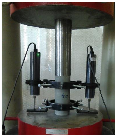
شکل (۳-۳۶) نمونه مغزه ماسه سنگ (4a) تحت آزمایش فشاری با جک یونیورسال و ستاپ ASTM
