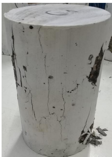
شکل (۳-۴۹) نمونه استوانه‌ای C1 (اسکن شده) پس از شکست با جک یونیورسال ۳۰۰ تن
