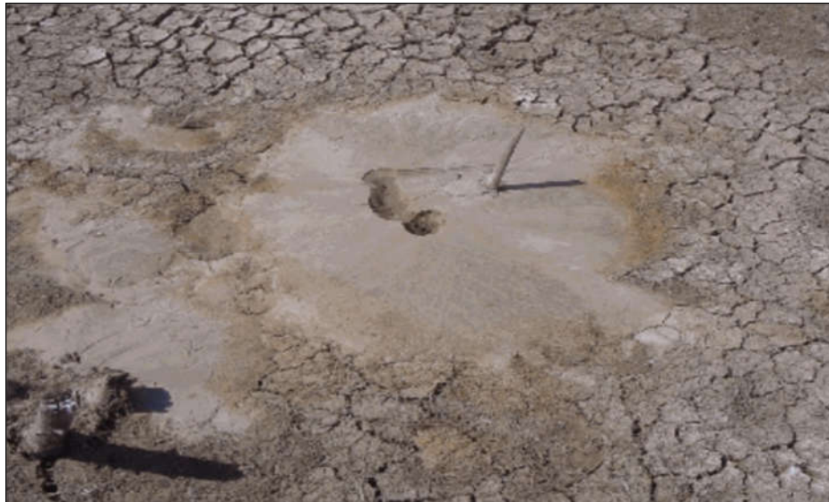
شکل (۱۶-۲) جوشش ماسه ای نقطه ای
