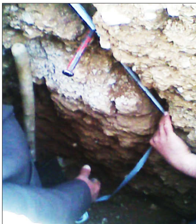
شکل (۳-۳۷) اندازه گیری طول ترک‌ها در داخل ترانشه شناسایی
