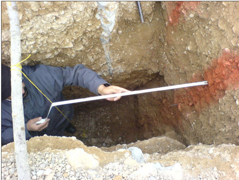
شکل (۳-۴۱) اندازه گیری فاصله ترک نسبت به محور قائم ثابت در داخل ترانشه شناسایی
