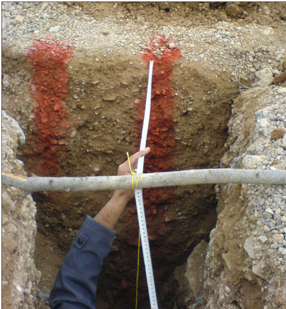
شکل (۳-۴۰) اندازه‌گیری فاصله ترک نسبت به محور قائم ثابت در داخل ترانشه شناسایی
