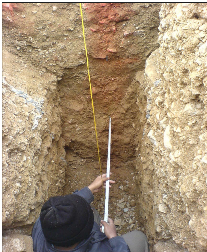
شکل (۳-۴۲) اندازه گیری فاصله ترک نسبت به محور قائم ثابت در داخل ترانشه شناسایی
