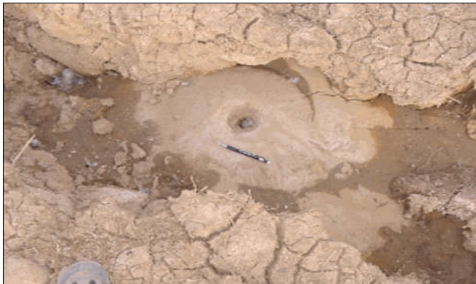
شکل (۱۷-۲) جوشش ماسه ای در مقیاس بزرگتر
