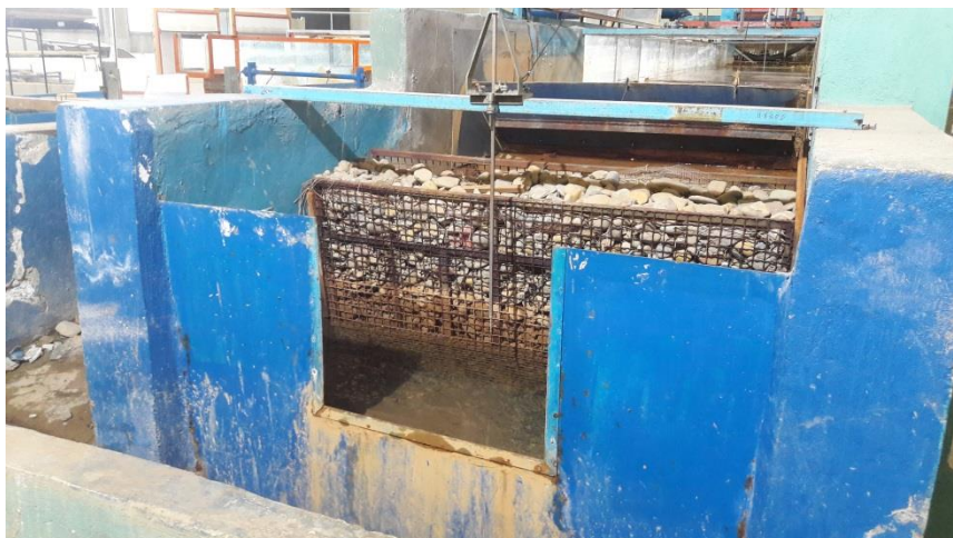
شکل ۳-۶: سرریز مستطیلی نصب شده در حوضچه آرامش به منظور اندازه‌گیری دبی جریان
