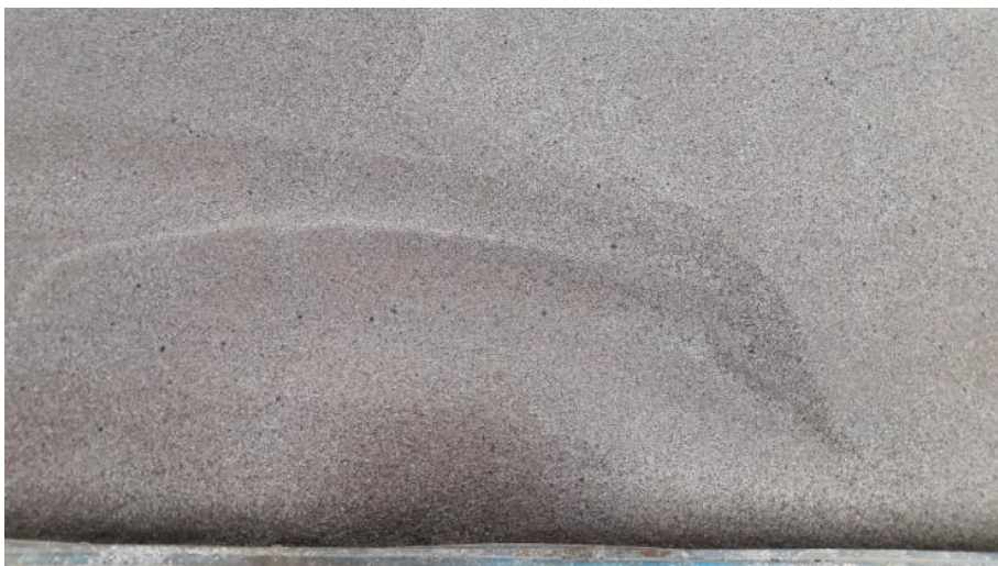
شکل ۴-۱۶- حفره بالادست در انتهای آزمایش با مشخصات \frac{l}{b} = 1/28 و \frac{s}{B} = 20\% و \frac{l}{y} = 8
