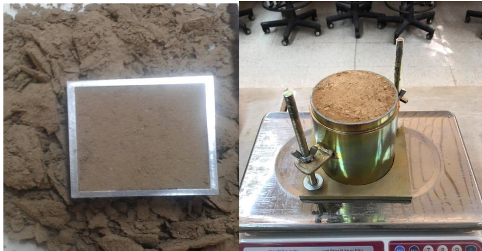
شکل (۳-۳) نمونه بازسازی شده از خاک دست خورده
