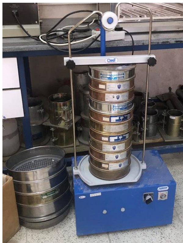
شکل (۳-۶) : الکهای آزمایش دانه بندی به روش تر(قسمت درشت دانه)
