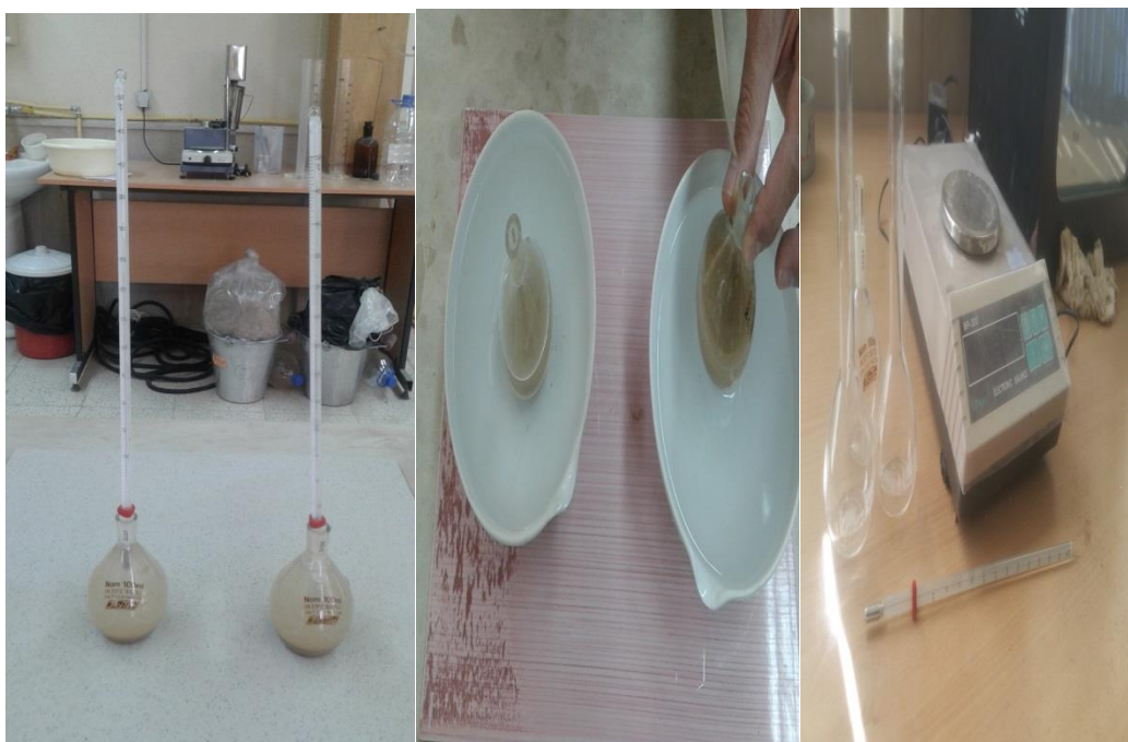
شکل (۳-۵) : وسایل آزمایش تعیین چگالی ویژه بخش جامد خاکهای ریزدانه
