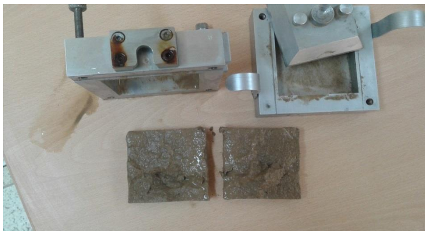
شکل (۳-۱۳) : نمونه پس از برش در دستگاه برش مستقیم
