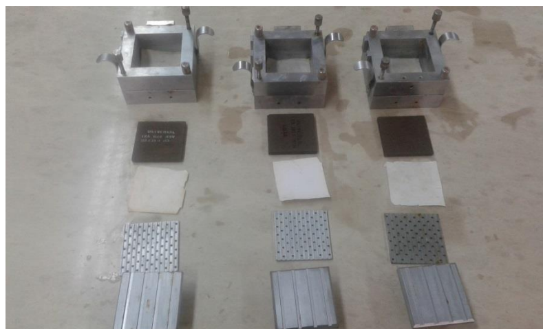
شکل (۴-۲) : قالبهای دستگاه برش مستقیم (مربعی)
