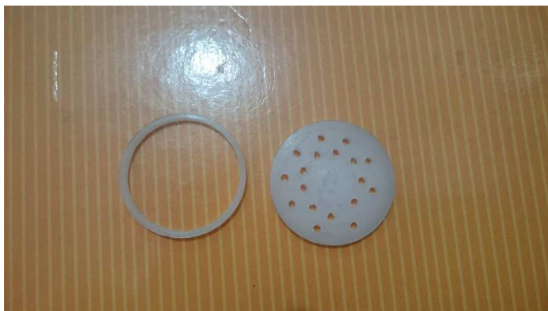
شکل ۳-۱۱. حلقه‌های تفلونی و دیسک تفلونی سوراخدار
