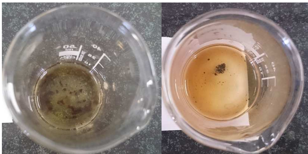
شکل ۴-۴. نانو سیال \text{Fe}_3\text{O}_4 در pH = ۴ (سمت راست) و pH=۱۱ (سمت چپ)
