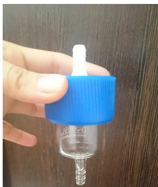
شکل ۳-۹. ستون شیشه‌ای با درپوش طراحی شده استفاده شده در این مطالعه
