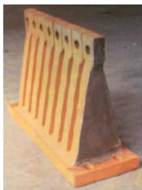
شکل (2-9): میراگر تسلیمی مثلثی شکل (TADAS) و منحنی پسماند آن [15]
