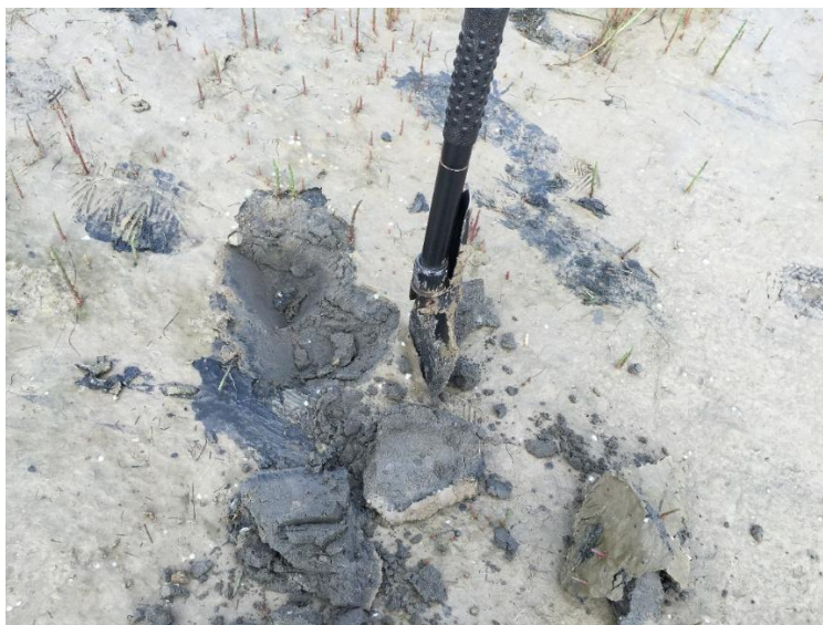
شکل (۵-۳۰) : رسوبات آغشته به مواد آلی در حجم رسوبی درون کانال آشوراده
