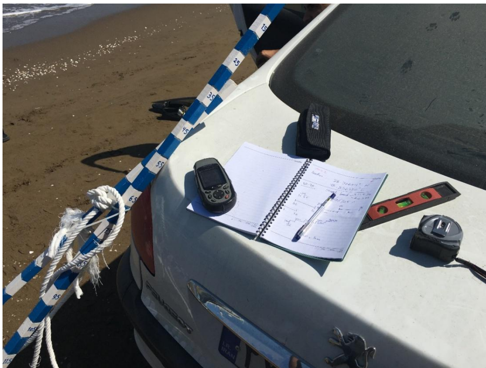
شکل (۴-۲): ابزار اندازه‌گیری شیب صورت ساحل شامل دو چوب مندرج ۲ متری، یک طناب ۵ متری، تراز، جی‌پی‌اس، متر
