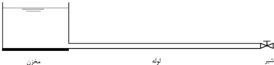
شکل ۱-۴: سیستم تک لوله‌ای
