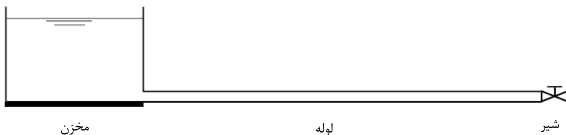
شکل ۳-۲: سیستم تک لوله
