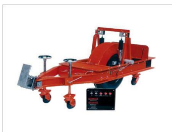
شکل ۳-۱۰- دستگاه ناهمواری سنج بامپ اینتگریتور
