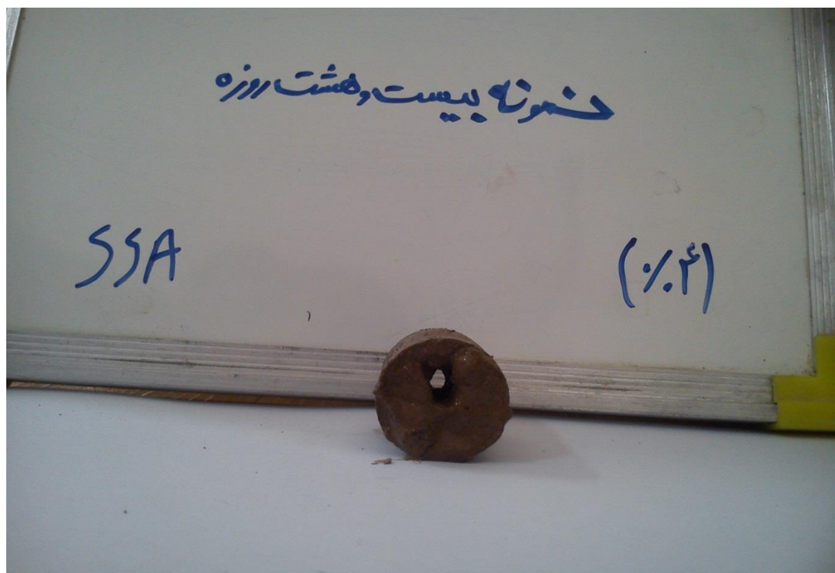
شکل (۴-۱۸) قطر نمونه SSA(4%) پس از اتمام آزمایش پین هول
