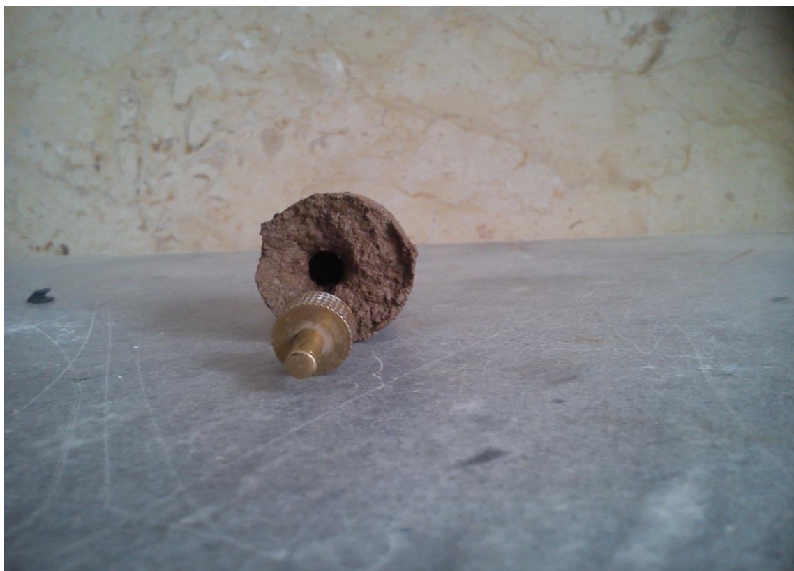
شکل (۴-۱۳) قطر نمونه خاک واگرا (خاک مورد مطالعه) بعد از آزمایش پین هول
