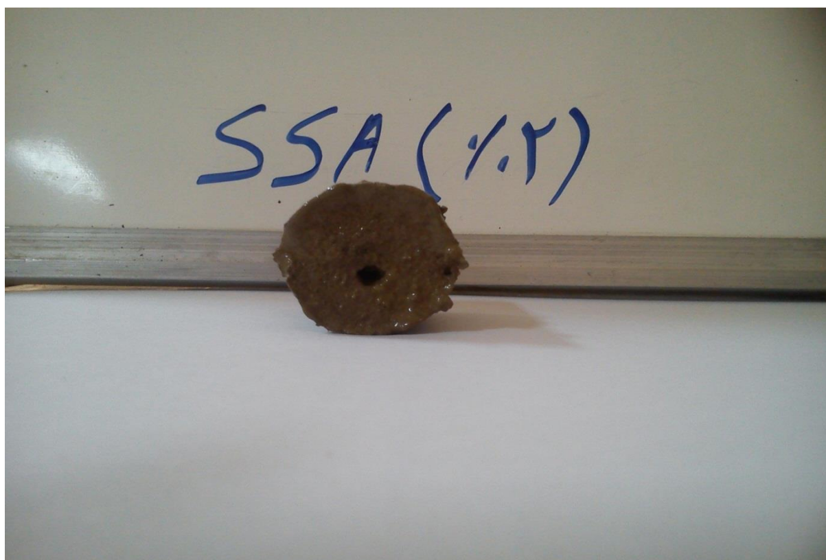
شکل (۴-۱۷) قطر نمونه SSA(2%) پس از اتمام آزمایش پین هول
