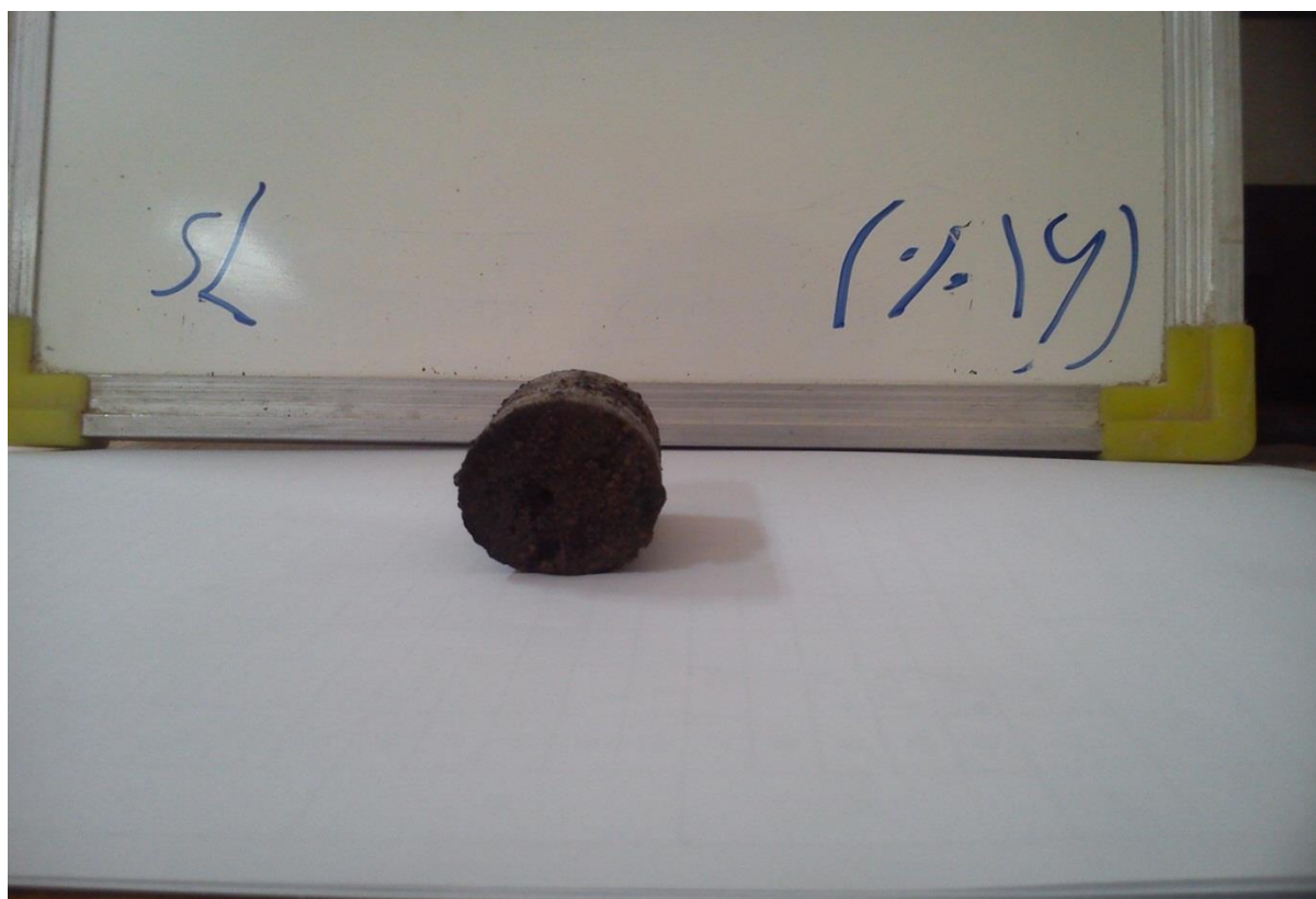
شکل (۴-۱۶) قطر نمونه SL(16%) پس از اتمام آزمایش پین هول
