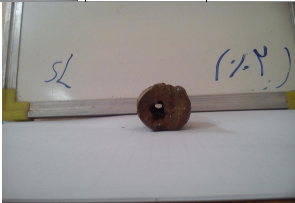
شکل (۴-۱۳) قطر نمونه SL(2%) پس از اتمام آزمایش پین هول
