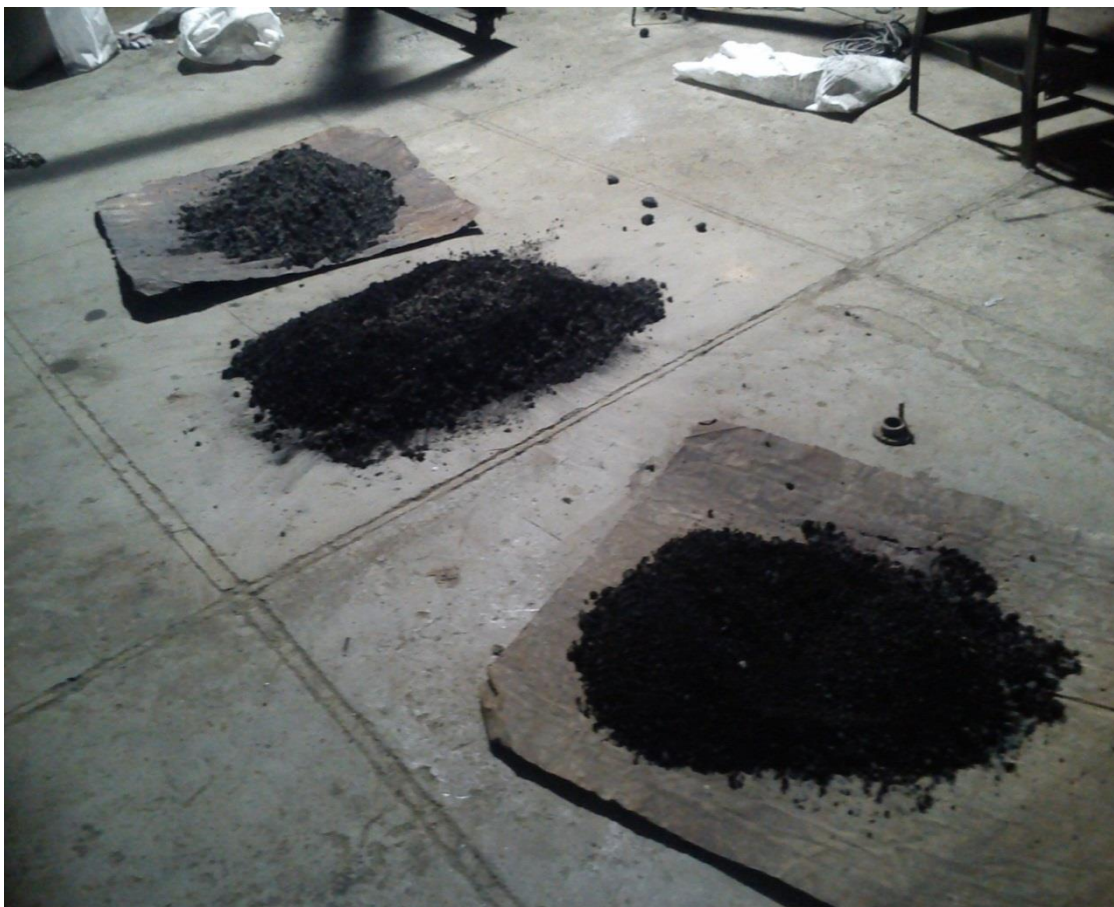
شکل (۴-۷) نمایی از خاکستر لجن فاضلاب حاصله از کوره
