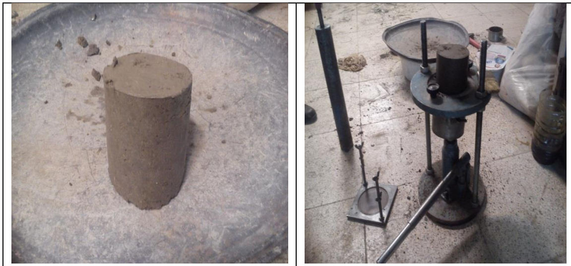
شکل (۳-۷) نمایی شماتیک از آزمایش تراکم
