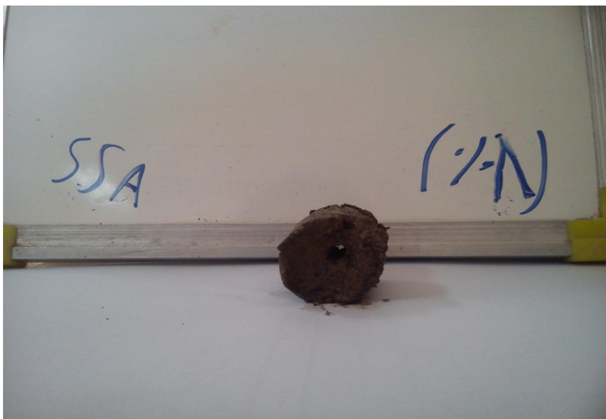
شکل (۴-۱۹) قطر نمونه SSA(8%) پس از اتمام آزمایش پین هول
