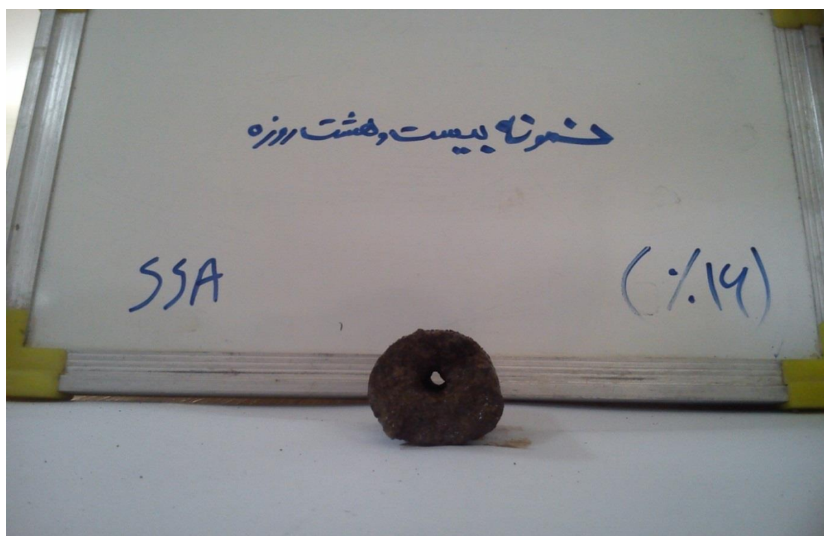
شکل (۴-۲۰) قطر نمونه SSA(16%) پس از اتمام آزمایش پین هول
