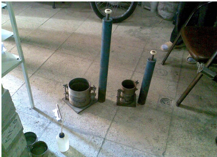
شکل (۳-۶) نمونه‌هایی از قالب و چکش تراکم
