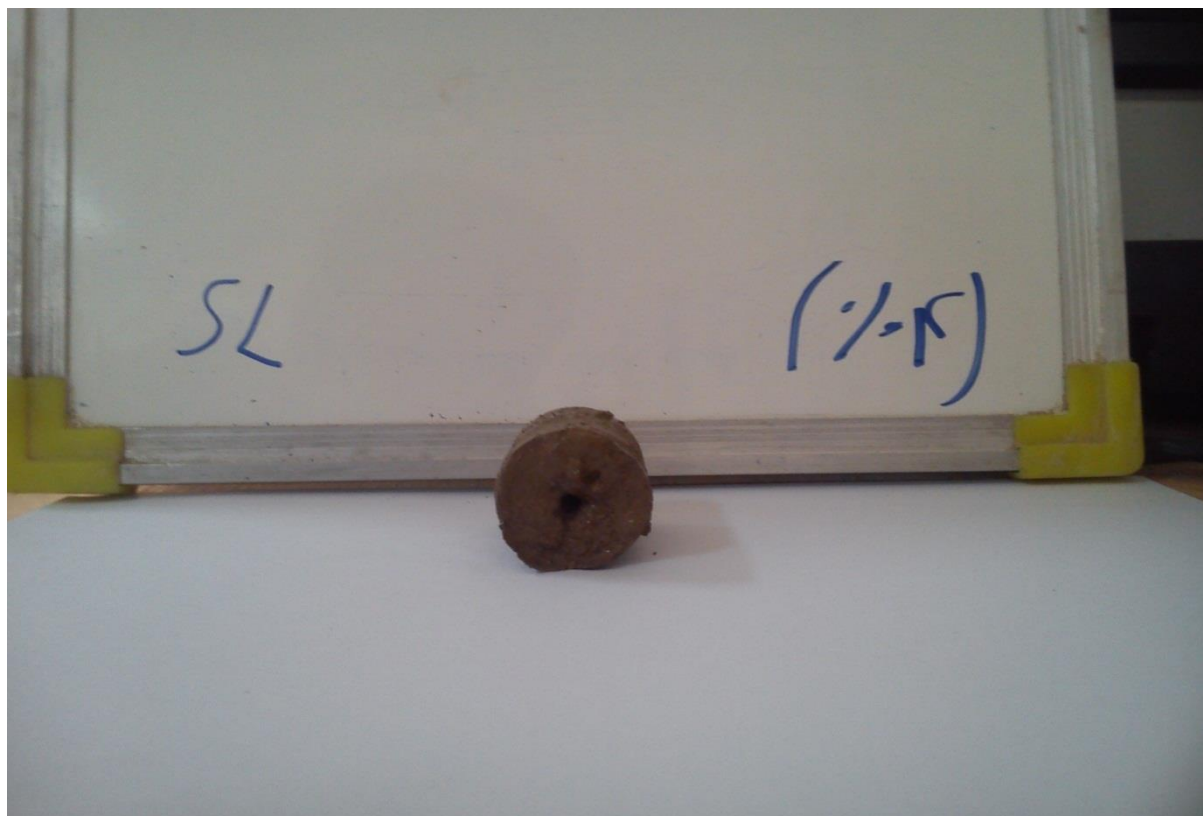
شکل (۴-۱۴) قطر نمونه SL(4%) پس از اتمام آزمایش پین هول
