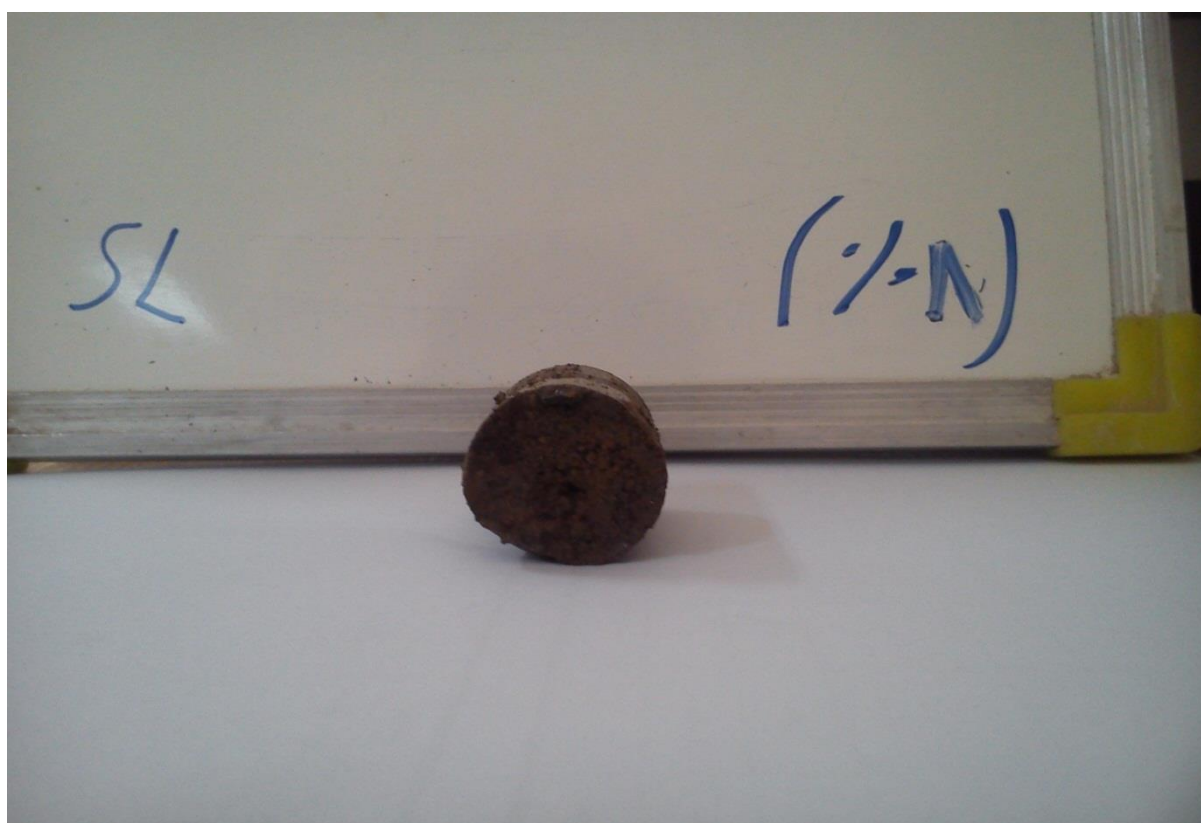
شکل (۴-۱۵) قطر نمونه SL(8%) پس از اتمام آزمایش پین هول
