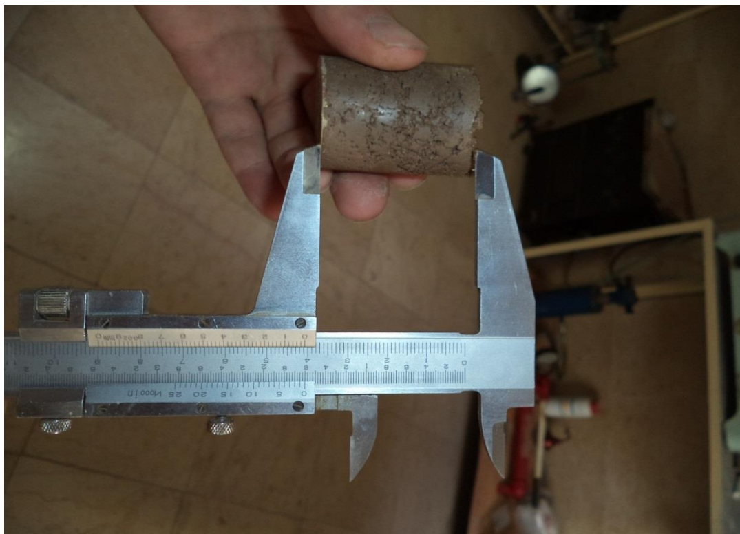
شکل (۴-۱۲) نمایی از طول استاندارد نمونه مورد مطالعه برای آزمایش پین هول
