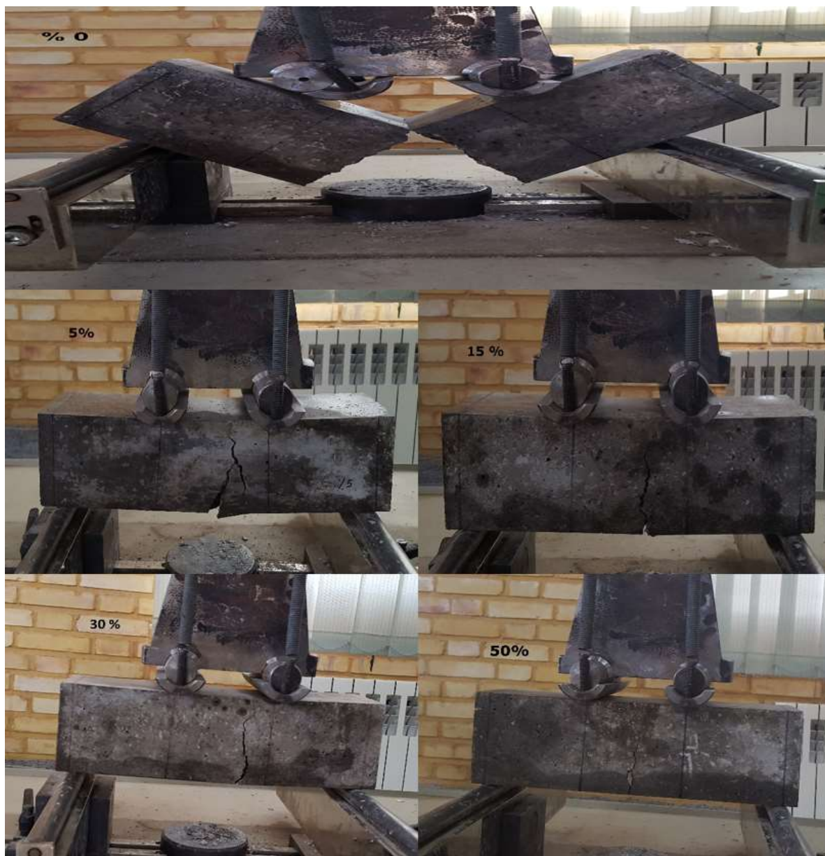
شکل ۴-۱۰ مقایسه شکست نمونه‌های خمشی و اندازه ترک برای درصدهای مختلف آزمایش
