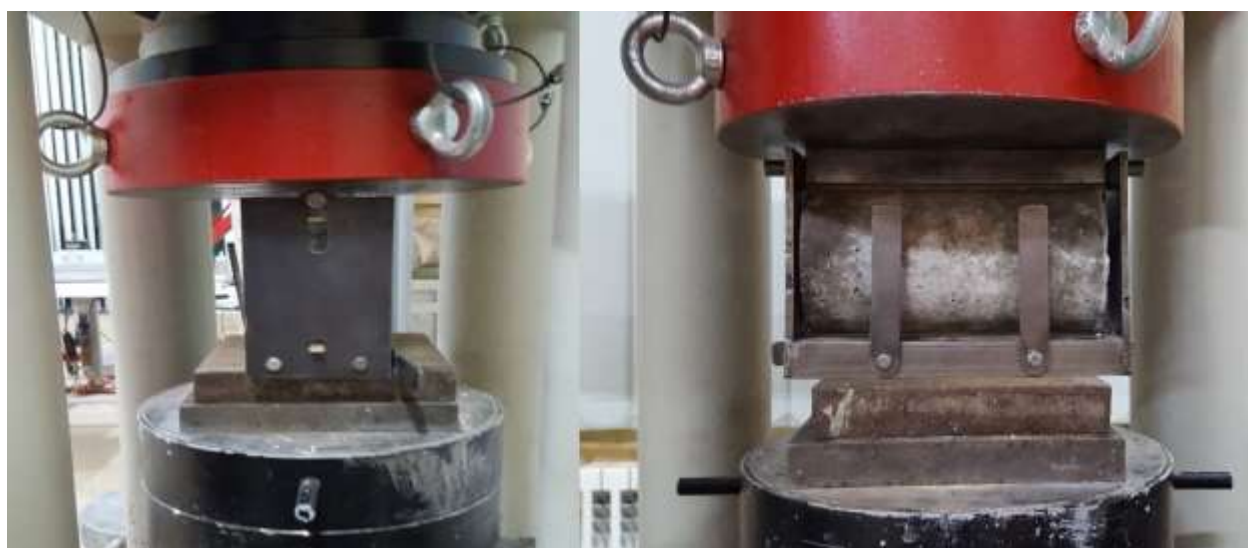
شکل ۴-۶ نمونه‌های مقاومت کششی غیرمستقیم قبل از آزمایش
