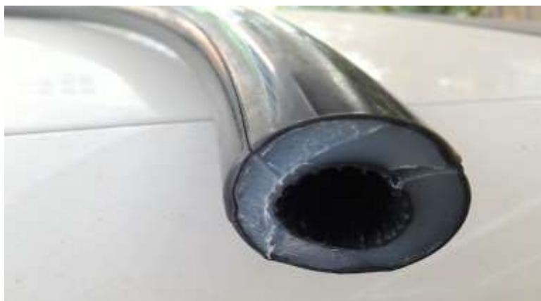
شکل ۳-۳ یک نمونه از ضایعات XLPE قبل از خرد شدن
