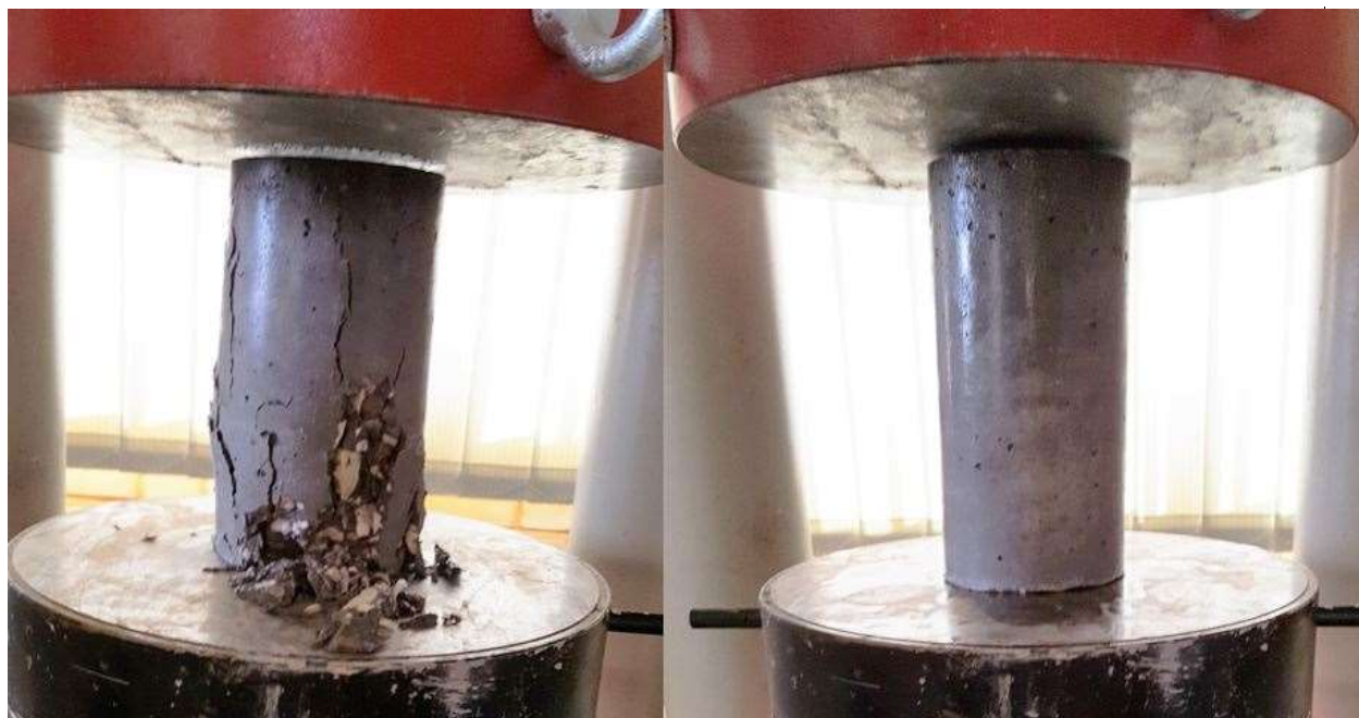
شکل ۳-۴ نمونه‌های مقاومت فشاری قبل و بعد از آزمایش
