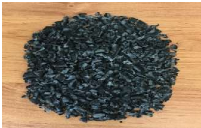
شکل ۳-۱ ضایعات XLPE در شکل و اندازه مورد استفاده
