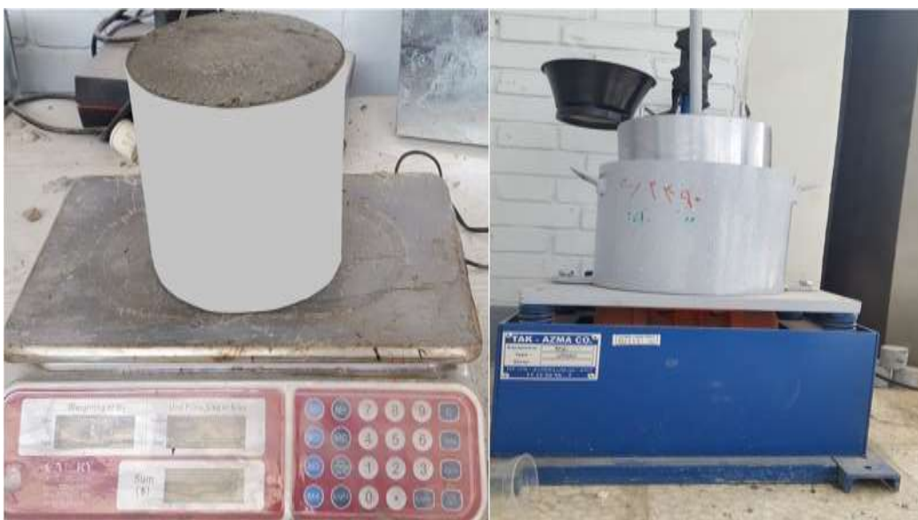
شکل ۳-۴ اندازه‌گیری زمان تراکم و چگالی بتن
