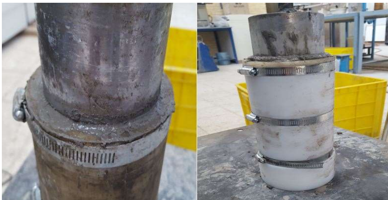
شکل ۳-۶ ساخت نمونه‌های استوانه‌ای با سر بار روی میز ویبره
