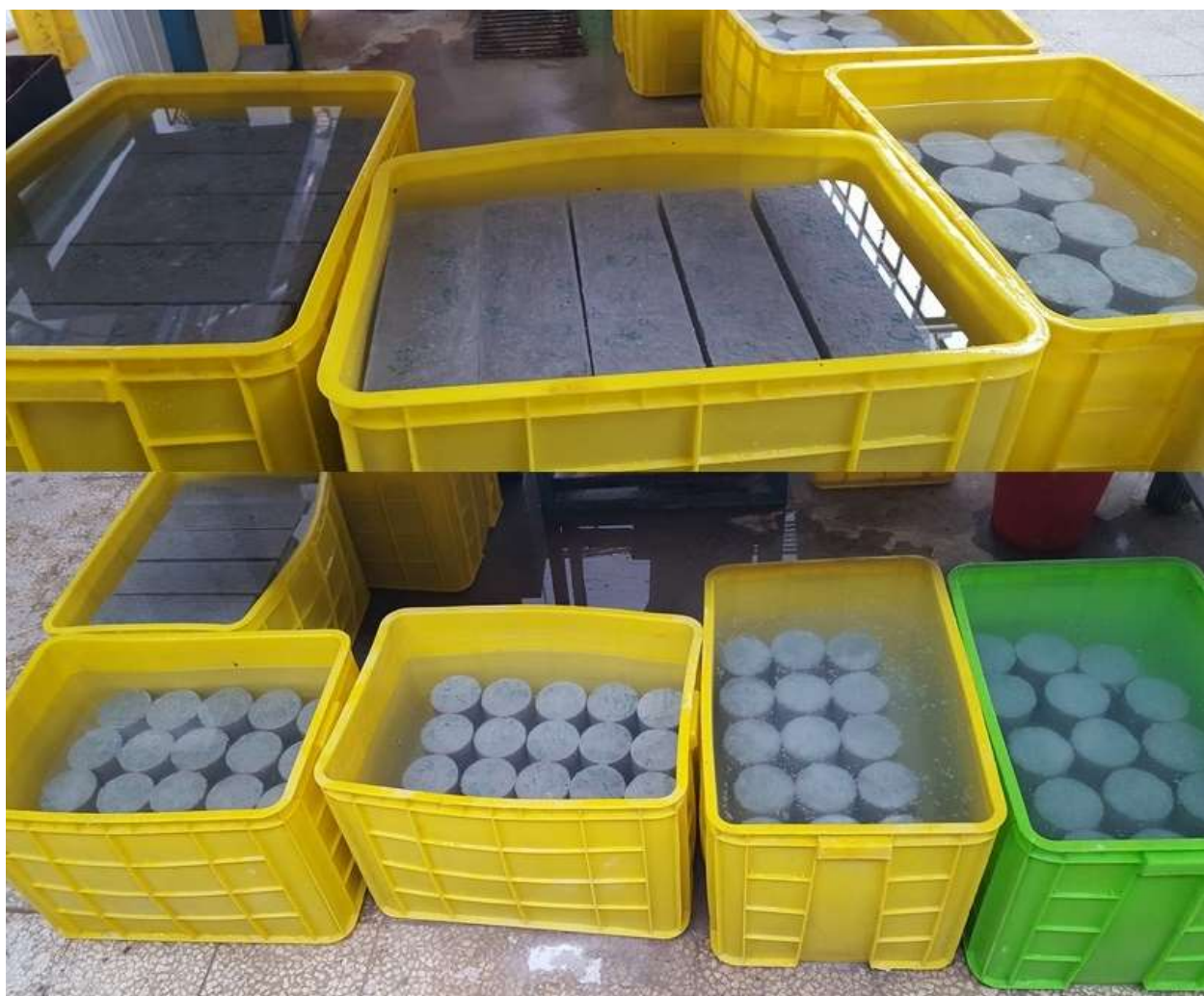
شکل ۹-۳ نحوه عمل آوری نمونه‌ها
