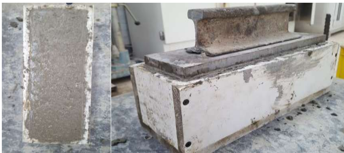
شکل ۳-۸ ساخت نمونه‌های آزمایش مقاومت خمشی تحت سربار و به‌وسیله میز ویبره
