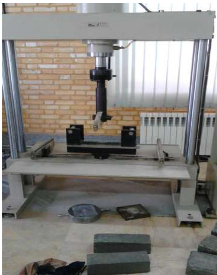
شکل ۳-۲- دستگاه جک هیدرولیکی استفاده شده برای آزمایش مقاومت خمشی
