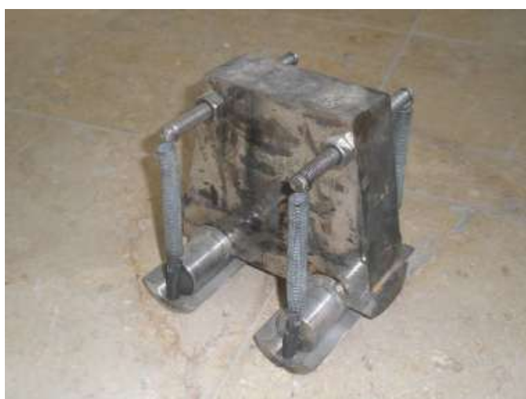
شکل ۳-۳- میله دوشاخه مورد استفاده در آزمایش مقاومت خمشی
