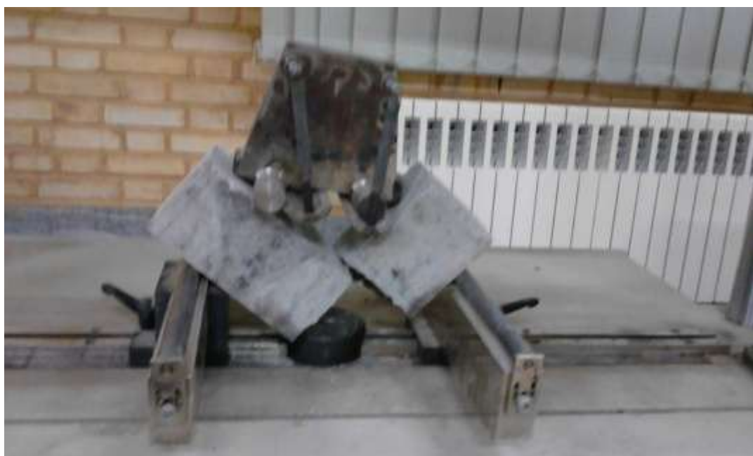
شکل ۴-۱۸- تیر بتنی بعد از اعمال بار در آزمایش مقاومت خمشی
