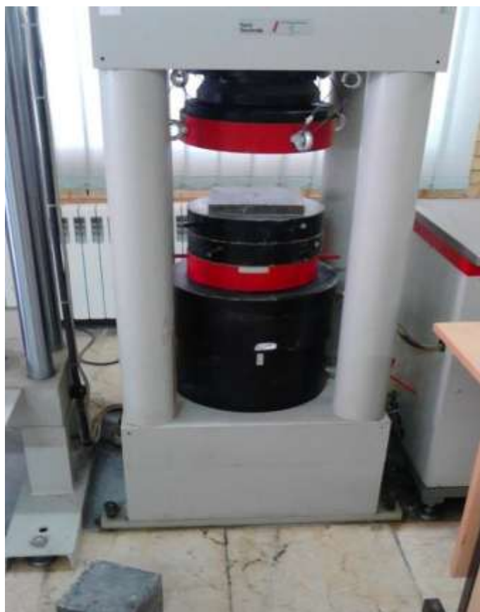
شکل ۳-۱- جک هیدرولیکی استفاده شده برای آزمایش مقاومت فشاری
