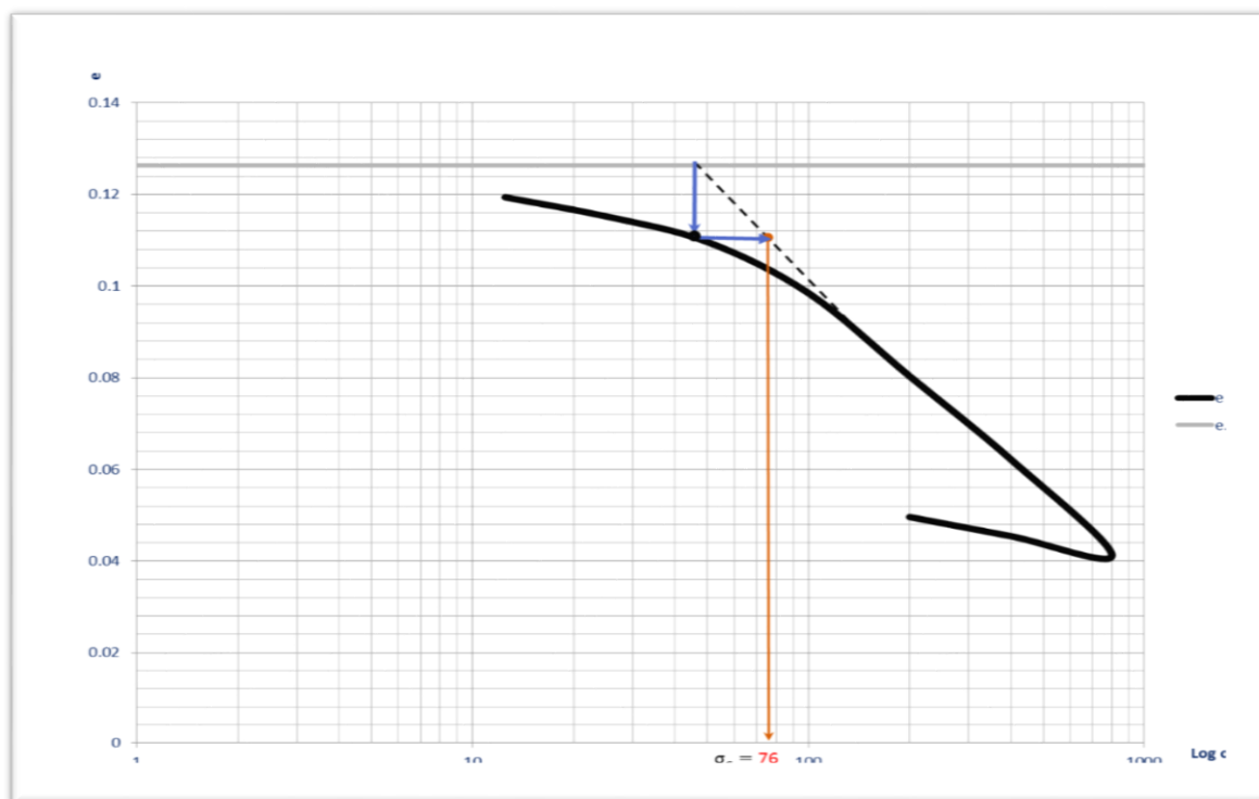
شکل ۴-۱۹. تعیین تنش پیش تحکیمی به روش سیلوا از نمودار تحکیم برای نمونه متراکم شده با انرژی 2700 \text{ kN.m/m}^3
