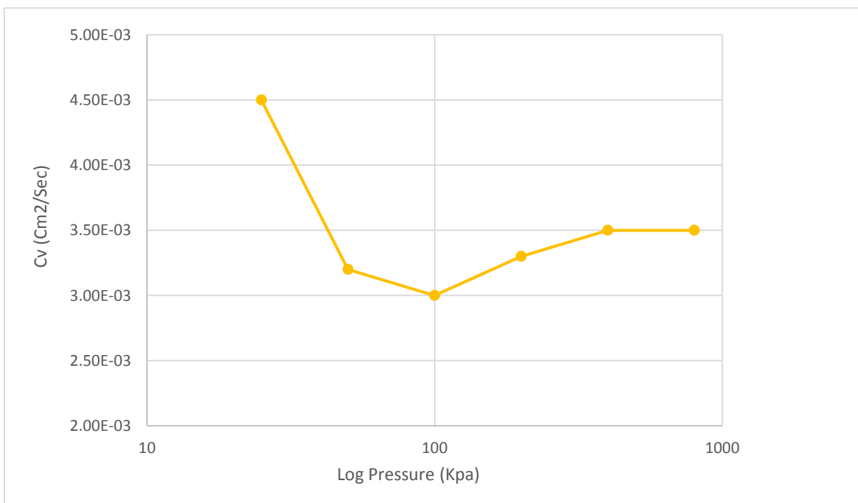
شکل ۴-۳۰. ضریب تحکیم به دست آمده از آزمایش تحکیم برای نمونه متراکم شده با انرژی 1620 \text{ KN.m/m}^3
