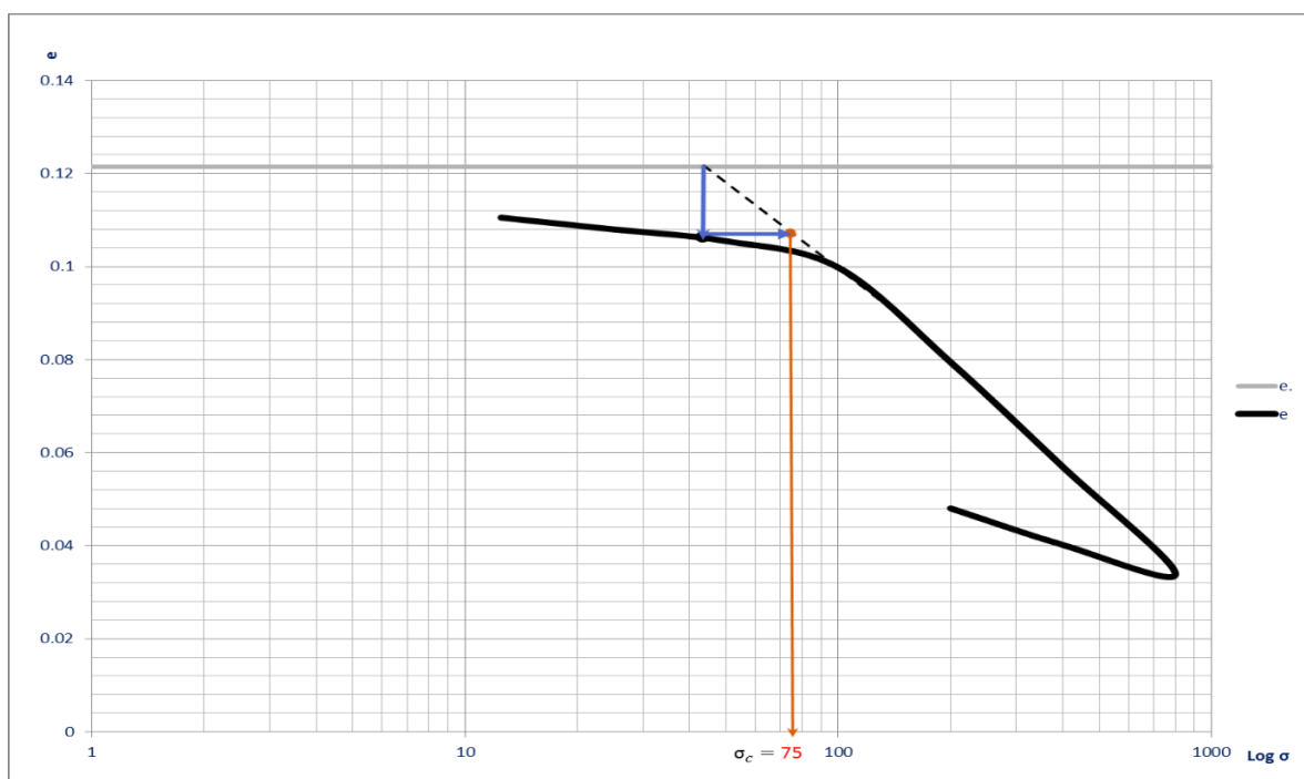
شکل ۴-۱۸. تعیین تنش پیش تحکیمی به روش سیلوا از نمودار تحکیم برای نمونه متراکم شده با انرژی ۱۶۲۰ \text{ kN.m/m}^3
