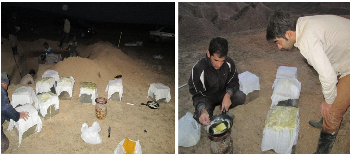
شکل ۳-۶ عایق کردن نمونه‌ها جهت حفظ رطوبت
