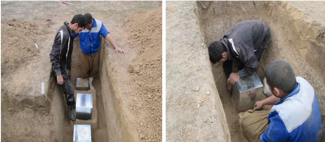
شکل ۳-۵ مراحل نمونه‌گیری دست‌نخورده
