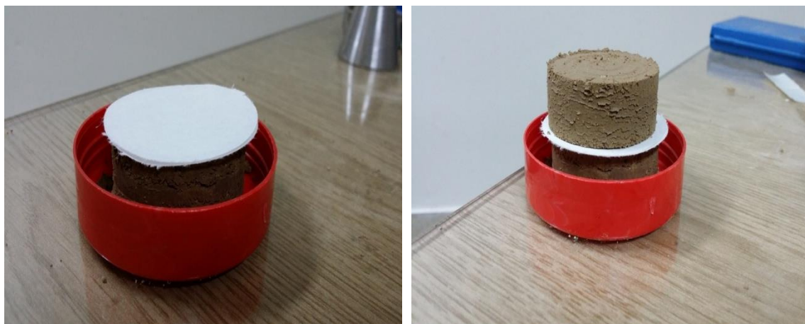
شکل ۳-۱۴ نحوه قرار گرفتن فیلتر کاغذی در روش تماسی
