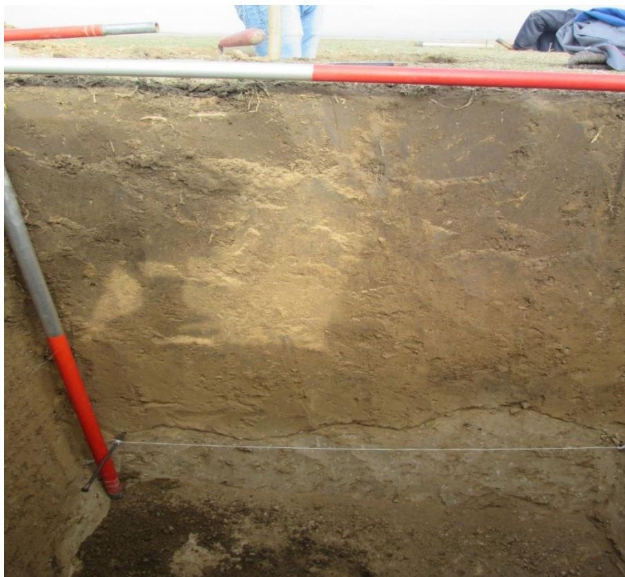
شکل ۳-۴ تعیین عمق خاک نباتی و رسیدن به تراز نمونه‌گیری
