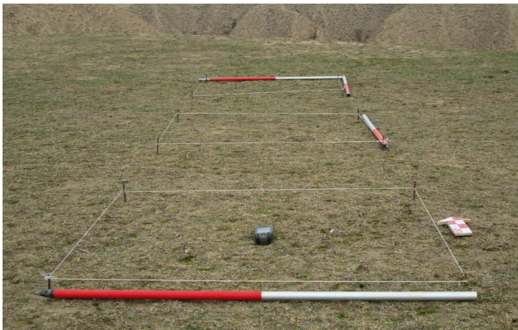
شکل ۳-۳ مشخص کردن محل‌های کندن زمین جهت نمونه‌گیری
