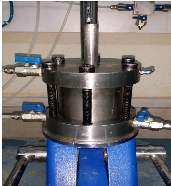
شکل ۳-۱۶ محفظه دستگاه تحکیم غیر اشباع
