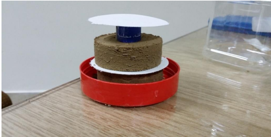
شکل ۳-۱۵ نحوه قرار گرفتن فیلتر کاغذی در روش غیر تماسی
