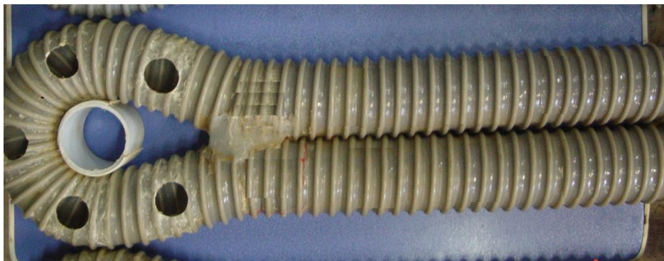
شکل ۳-۵: لوله مکش با قطر ۶/۱ سانتی متری
