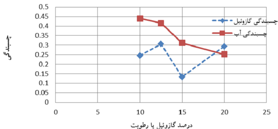
شکل ۲-۴۶- مقایسه تغییرات در درصد های مختلف آب و گازوئیل
