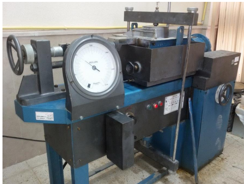
شکل ۳-۳- دستگاه برش مستقیم بزرگ مقیاس مورد استفاده
