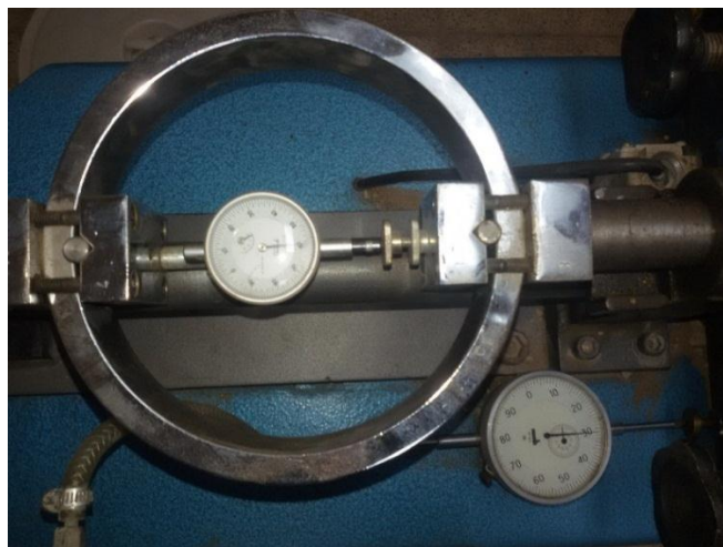
شکل ۳-۶- گیج های اندازه گیری نیرو و جابجایی افقی
