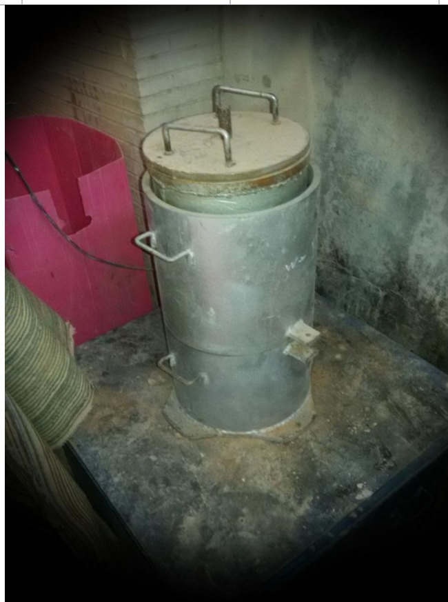
شکل ۳-۲- نمونه خاک تحت فشار بر روی میز مرتعش
