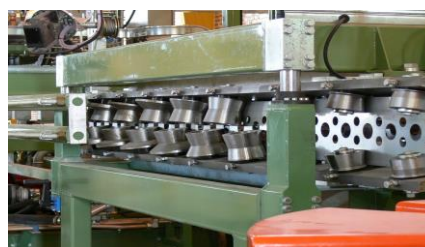
شکل (۲-۹) عملیات رول فرمینگ، رولهای فلزی پانچ شده
