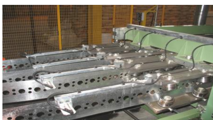
شکل (۲-۹) عملیات رول فرمینگ، رولهای فلزی پانچ شده
