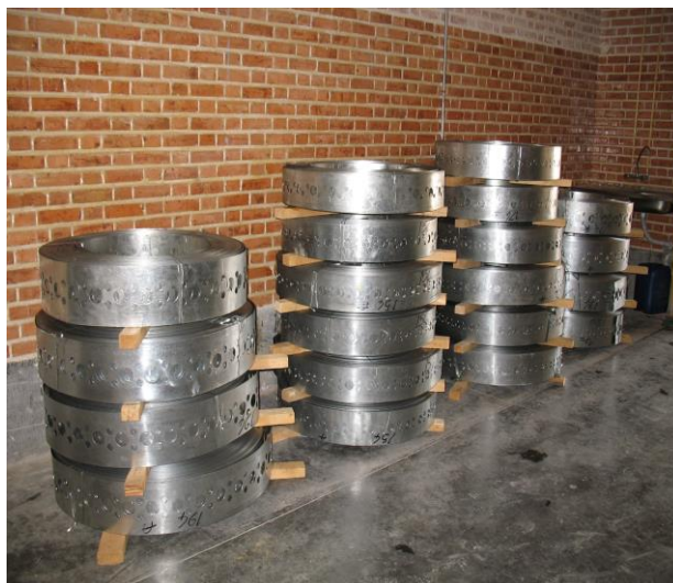
شکل (۲-۸) رولهای فلزی پانچ شده مربوط به پارتیشن‌ها و پانل‌های سقفی
