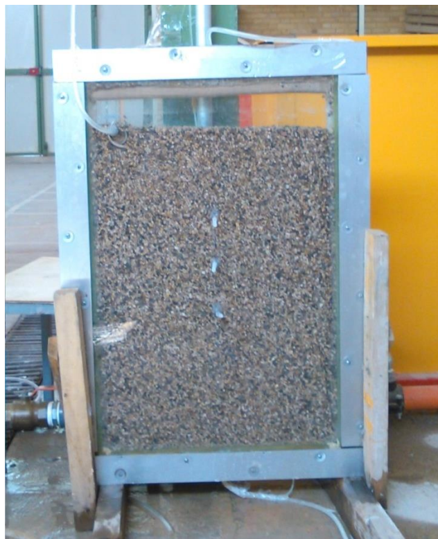
شکل (۳-۱۱) تصویر سیستم محیط متخلخل دو بعدی اجرا شده در آزمایشگاه
