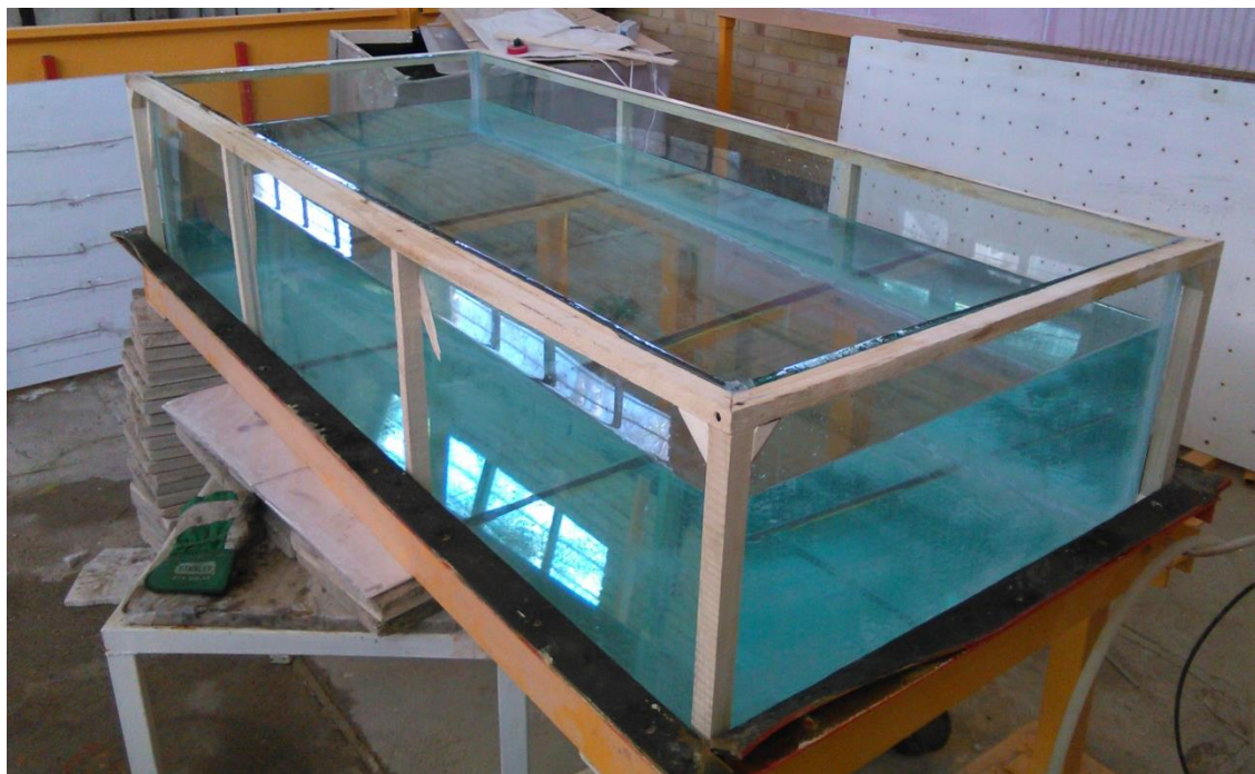
شکل (۳-۱۴) عکس از روند ساخت سیستم محیط متخلخل سه بعدی در آزمایشگاه
