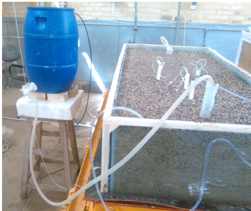
شکل (۳-۱۶) عکس از روند ساخت سیستم محیط متخلخل سه بعدی در آزمایشگاه
