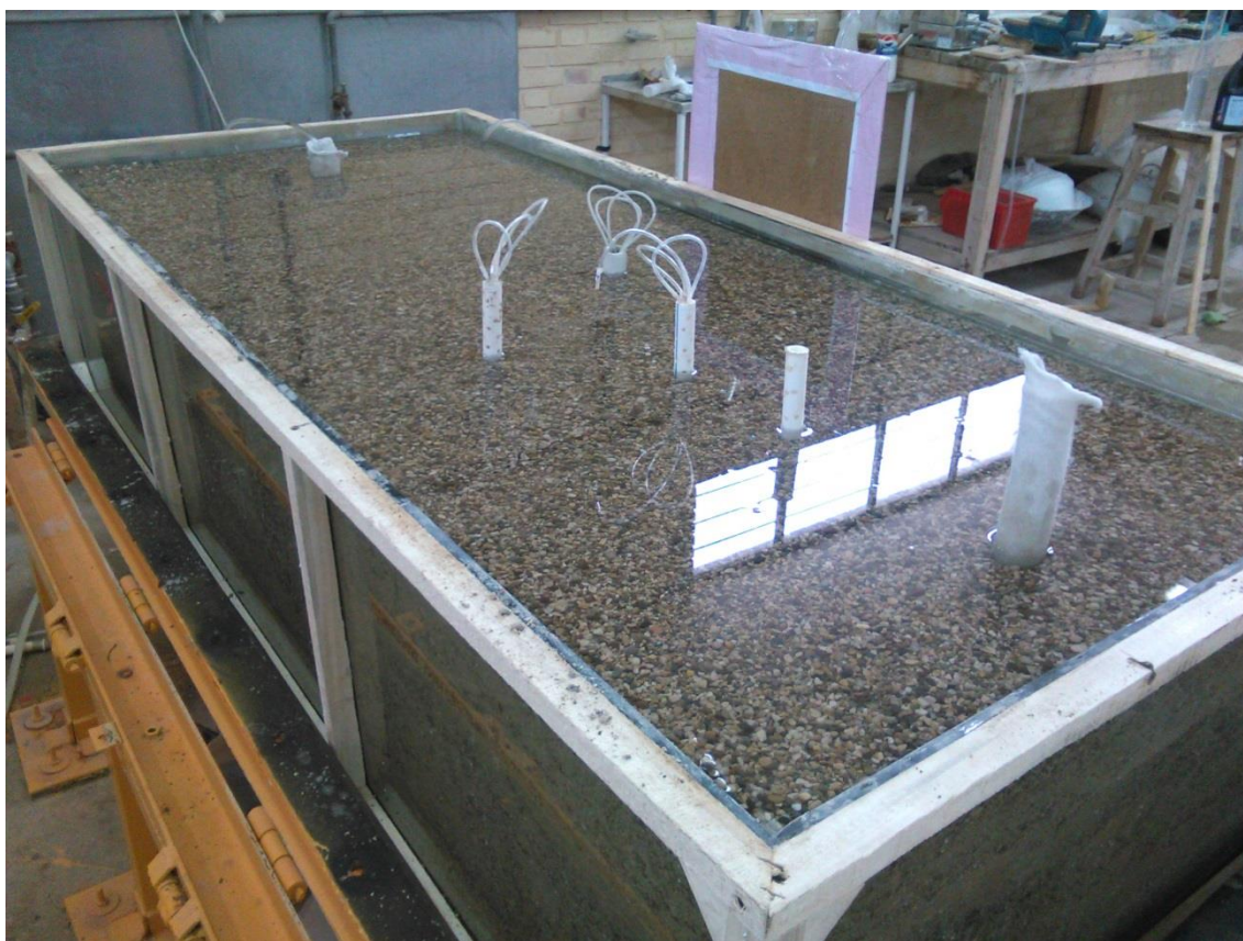
شکل (۳-۱۵) عکس از روند ساخت سیستم محیط متخلخل سه بعدی در آزمایشگاه
