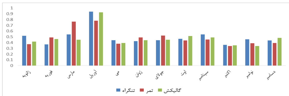
شکل ۵-۵: ضریب همبستگی محاسبه شده حداکثر دبی ماهانه ایستگاه‌های باران‌سنجی و سیگنال‌های بزرگ مقیاس اقلیمی
