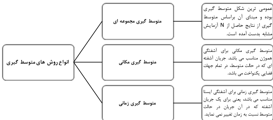
شکل ۳-۳ شماتیکی از انواع روش‌های متوسط‌گیری و تعاریف آن‌ها
