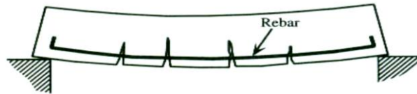
شکل ۱-۸- ترک‌ها در یک تیر بتن آرمه
