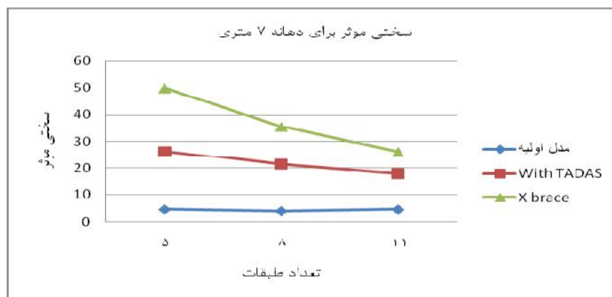
شکل (۵-۲۴) مقایسه سختی موثر قاب‌های انتخابی برای حالات مختلف مدلسازی با دهانه‌های ۷ متری
