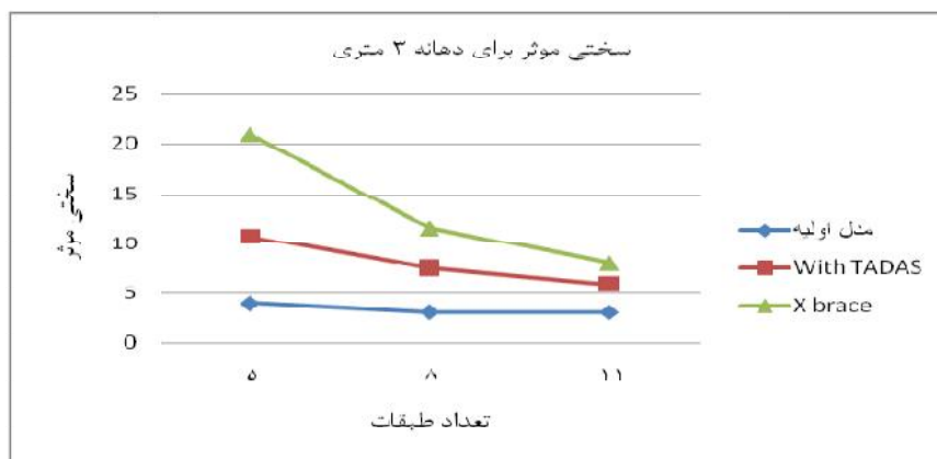
شکل (۵-۲۳) مقایسه سختی موثر قاب‌های انتخابی برای حالات مختلف مدلسازی با دهانه‌های ۳ متری
