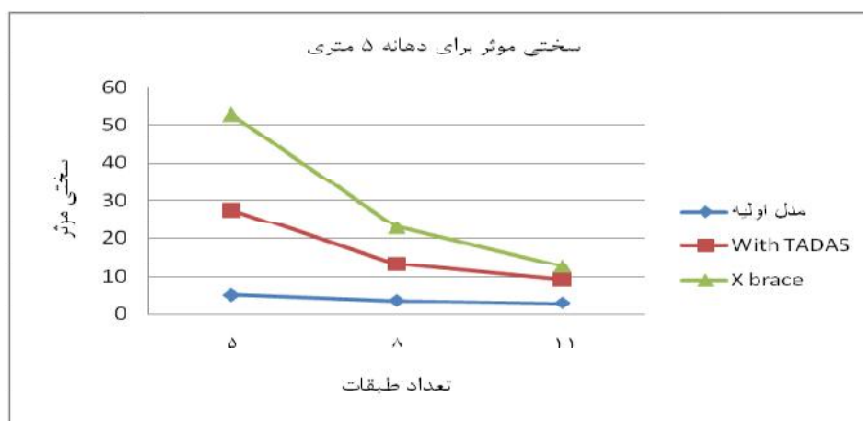
شکل (۵-۲۴) مقایسه سختی موثر قاب‌های انتخابی برای حالات مختلف مدلسازی با دهانه‌های ۵ متری
