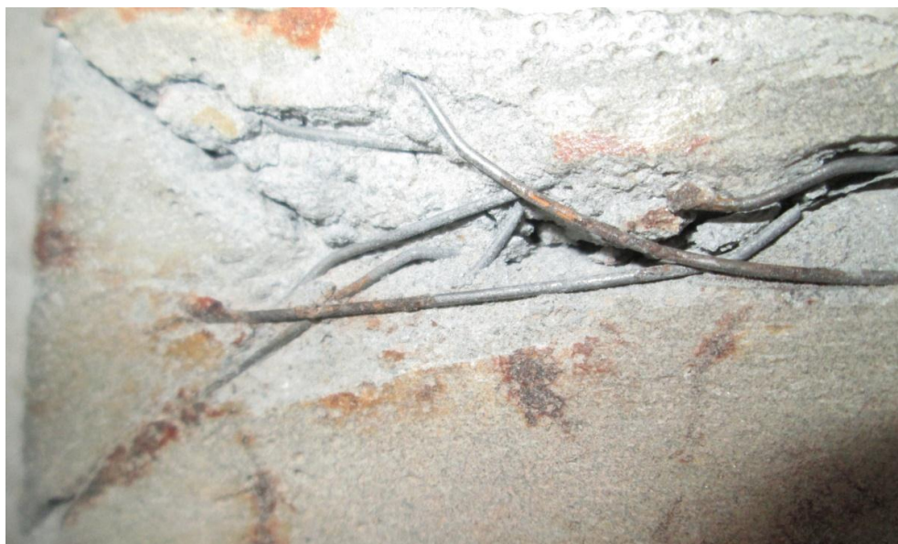
شکل (۳۴-۵): الیاف قرار گرفته در سطح نمونه - الیاف قلابدار (بعد از تراشیدن سطح)
