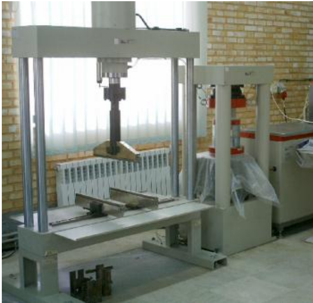
شکل (۴-۵): دستگاه خمش و فشار برای کنترل کیفیت مصالح ساختمانی
