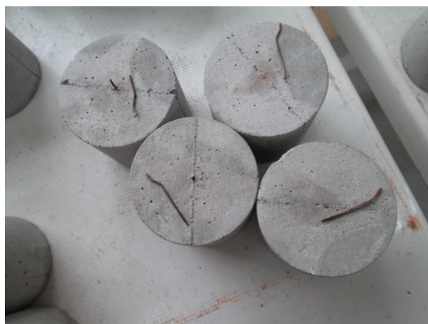
شکل (۵-۴۶): شکست کششی و گسیختگی الیاف (SFRC3)
