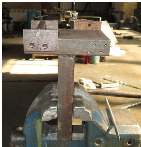
شکل (۵-۱۵): پروفیل ساخته شده برای بارگذاری آزمایش خمش چهار نقطه‌ای
