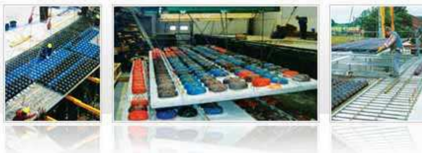
شکل ۲-۴- قابلیت اجرای سقف کوبیاکس به صورت پیش ساخته
