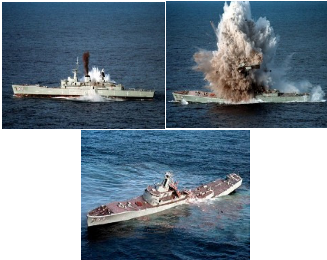
شکل ۱-۱ تصاویری از یک انفجار زیر آب که دقیقاً در زیر کشتی رخ داده است.
