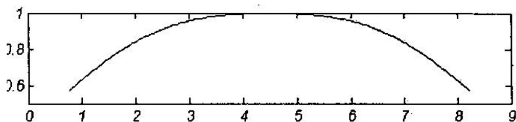
شکل ۱۰-۶: عملیات درون‌یابی در حالتی که طول دامنه هموارساز 2.6 است با استفاده از روش SPH.
