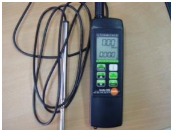
شکل (۶-۱): نمایی از یک دستگاه Hot wire جهت اندازه گیری سرعت هوا
