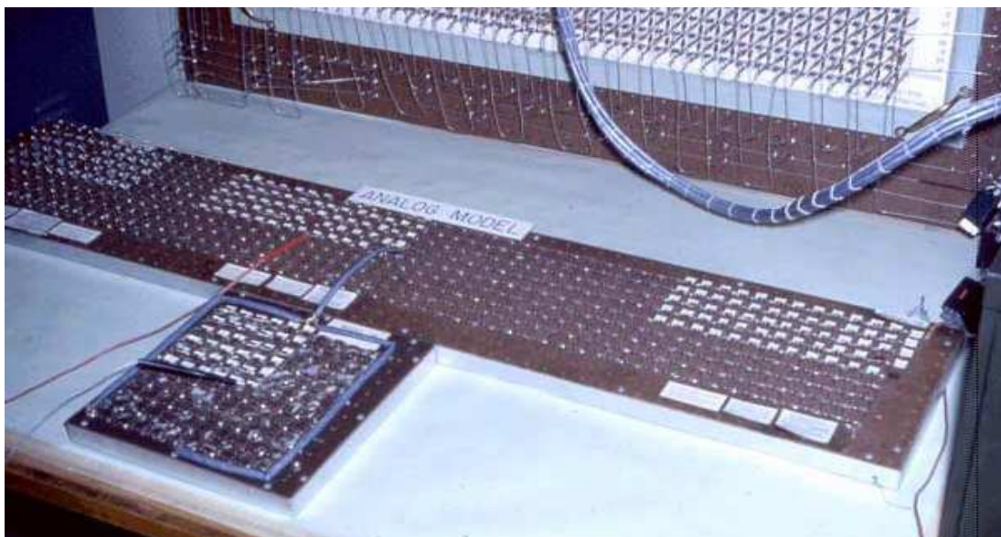
شکل (۴-۱) مجموعه‌ای از خازن و مقاومت الکتریکی که هیدرولیک جریان آب زیرزمینی را در یک آبخوان بوسیله مدل قیاسی نشان می‌دهد
