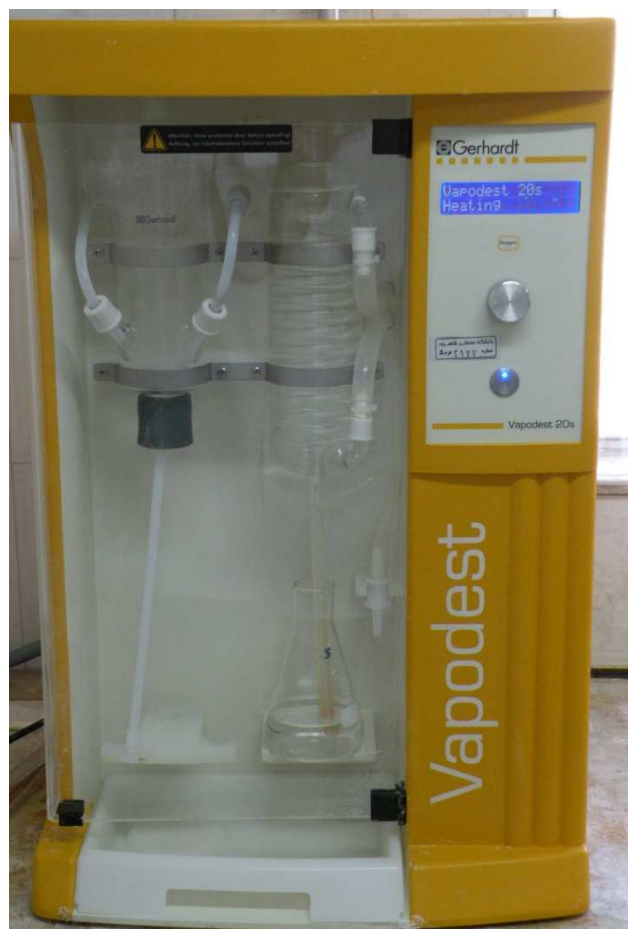
شکل (۷-۳) بخش تقطیر از دستگاه کج‌لدا
