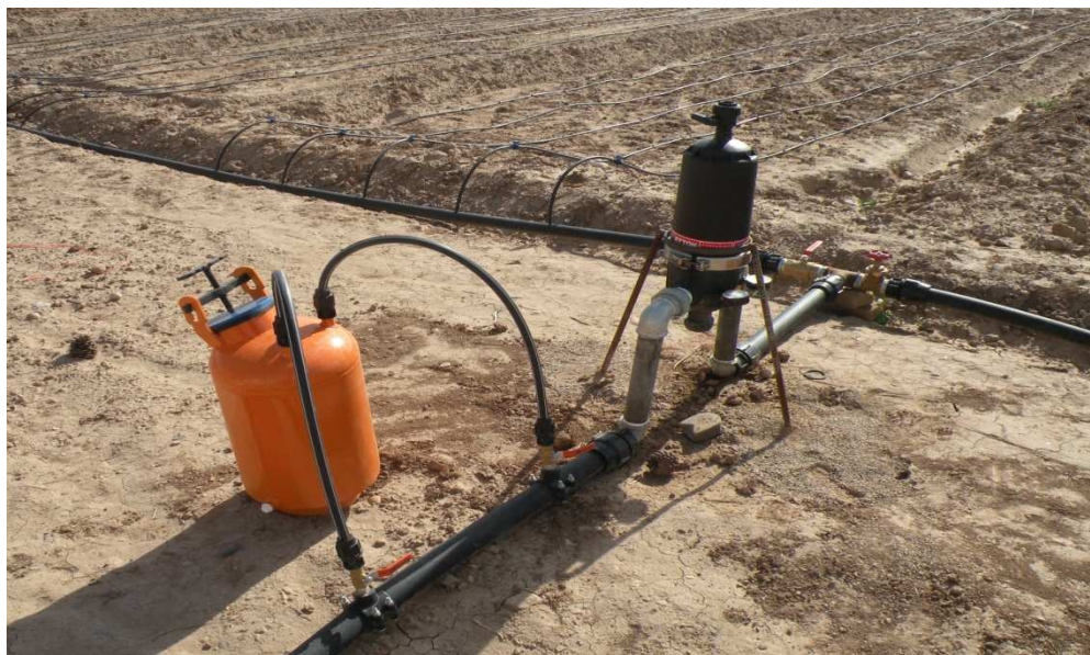
شکل (۳-۴) اجزای سیستم آبیاری قطره‌ای نصب شده در مزرعه تحقیقاتی قبل از کشت
