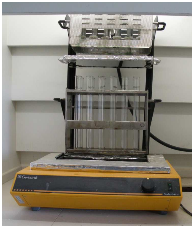
شکل (۶-۳) بخش هضم از دستگاه کج‌دال
