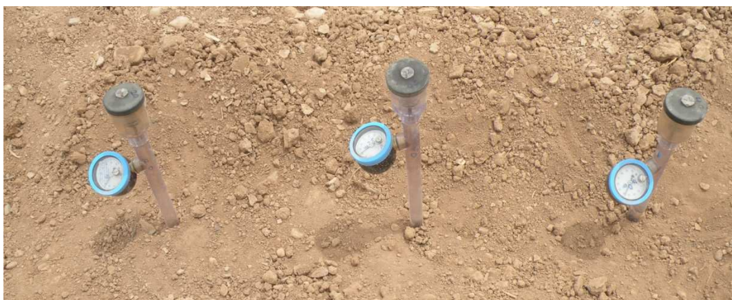
شکل (۳-۳) نصب تانسومتر جهت کنترل مکش رطوبت خاک
