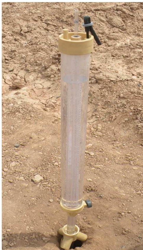
شکل (۲-۳) نصب دستگاه گلف جهت تعیین هدایت هیدرولیکی اشباع در اعماق مختلف
