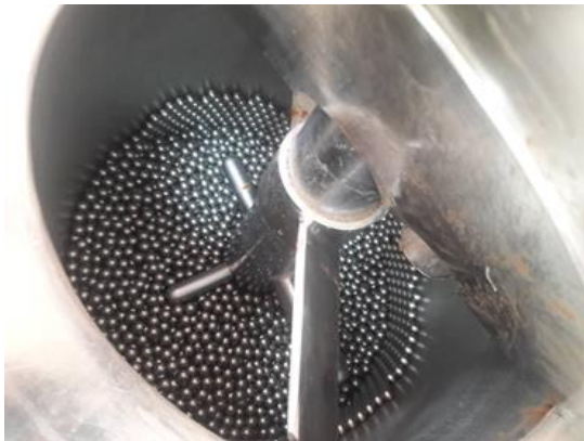
(شکل ۳-۶) مخزن داخلی دستگاه بالمیل
