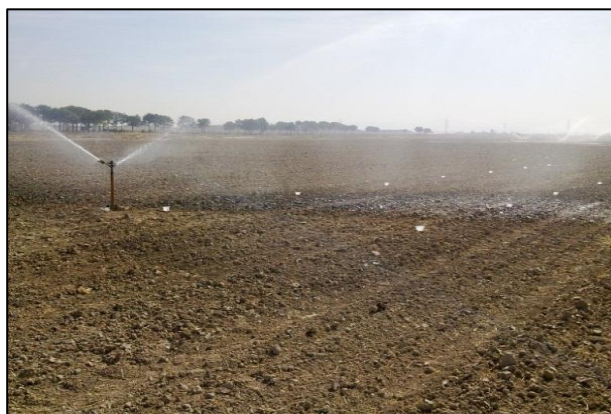
شکل ۳-۶- شروع به کار آبپاش پس از پیاده کردن شبکه اندازه گیری یکنواختی توزیع آب
