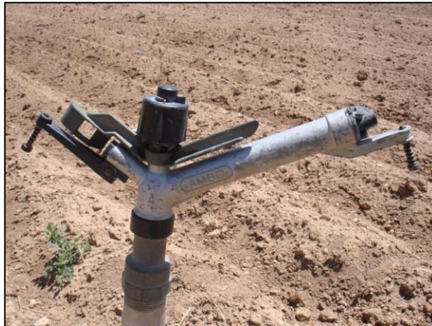
شکل ۴-۵۰- قرار نداشتن پیچ‌های تنظیم آبپاش‌ها در مسیر جت خروجی از آنها
