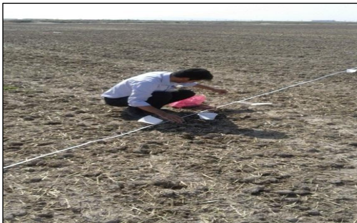
شکل ۳-۲- شبکه بندی با متر فلزی
