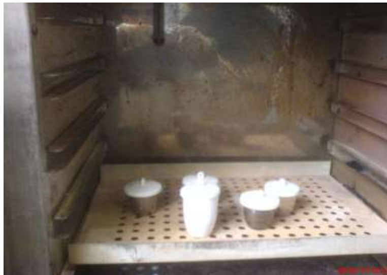
شکل ۳-۳ اندازه گیری ماده خشک با استفاده از آون با دمای 102^{\circ}\text{C}
