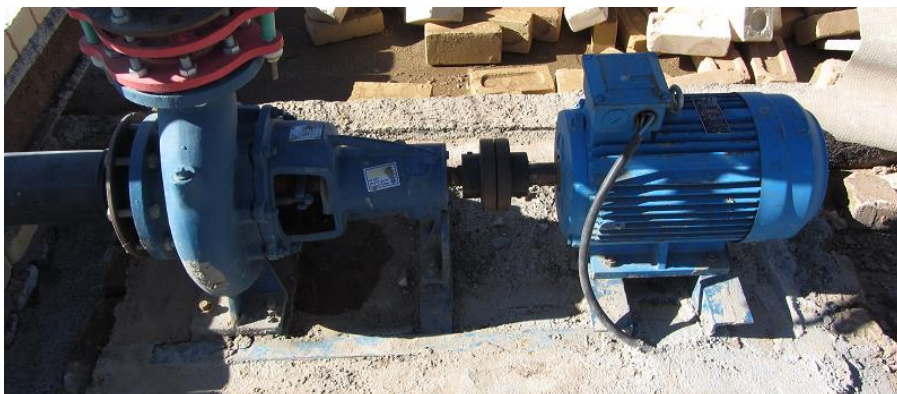
شکل (۱-۳) - نمایی از پمپ و الکتروموتور مورد استفاده در مدل آزمایشگاهی
