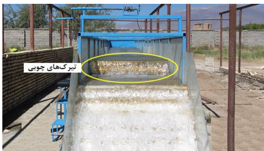
شکل (۳-۶) - تیرک‌های سدکننده و سرریز پلکانی نصب شده در انتهای فلوم
