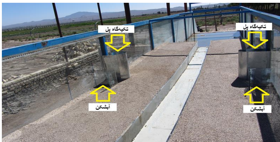
شکل (۳-۱۰) - موقعیت قرارگیری تکیه‌گاه‌ها و آبشکن در سیلاب‌دشت
