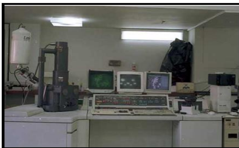
شکل ۳-۶ دستگاه میکروسکوپ الکترونی روبشی (SEM)، به منظور بررسی مورفولوژی نانوحامل‌ها
