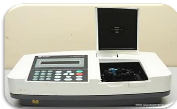
شکل ۳-۵ دستگاه اسپکتروفتومتر نور مرئی مدل Ultrospec 2000 ساخت انگلیس.
