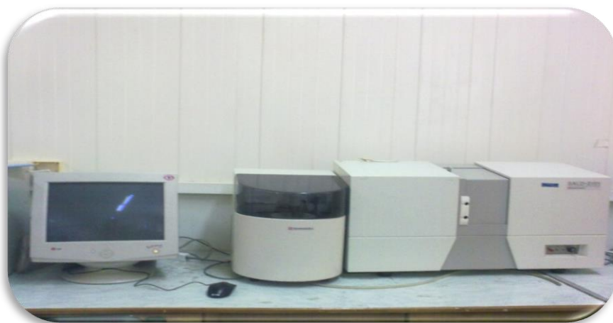
شکل ۳-۴ دستگاه اندازه‌گیری اندازه ذرات مدل Nanophox برای اندازه‌گیری قطر متوسط ذرات.
