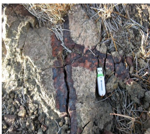
شکل ۲-۲۶ نمایش اثر عملکرد شکستگی (سبز رنگ) و عبور سیال حاوی کربنات مس شکل ۲-۲۷ نمایی از شکستگی‌های قرمز رنگ در تراکی آندزیت، در محل کانسار که محل عبور سیال را نشان می‌دهد.
