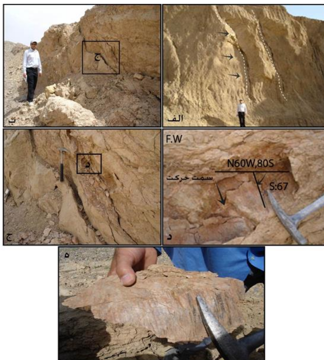
شکل ۳-۱۴ (الف) و (ب) رخنمون گسل البرز در ایستگاه شماره ۸، ایجاد شکستگی در اثر فعالیت گسل، سمت نگاه شمال‌خاوری، (ج) نمای نزدیک از رخنمون گسل، (د) موقعیت صفحه گسل و خش‌لغز به همراه سمت حرکت بلوک فرودیواره، (ه) نمای نزدیک از آثار لغزش بر روی سطح گسل.
