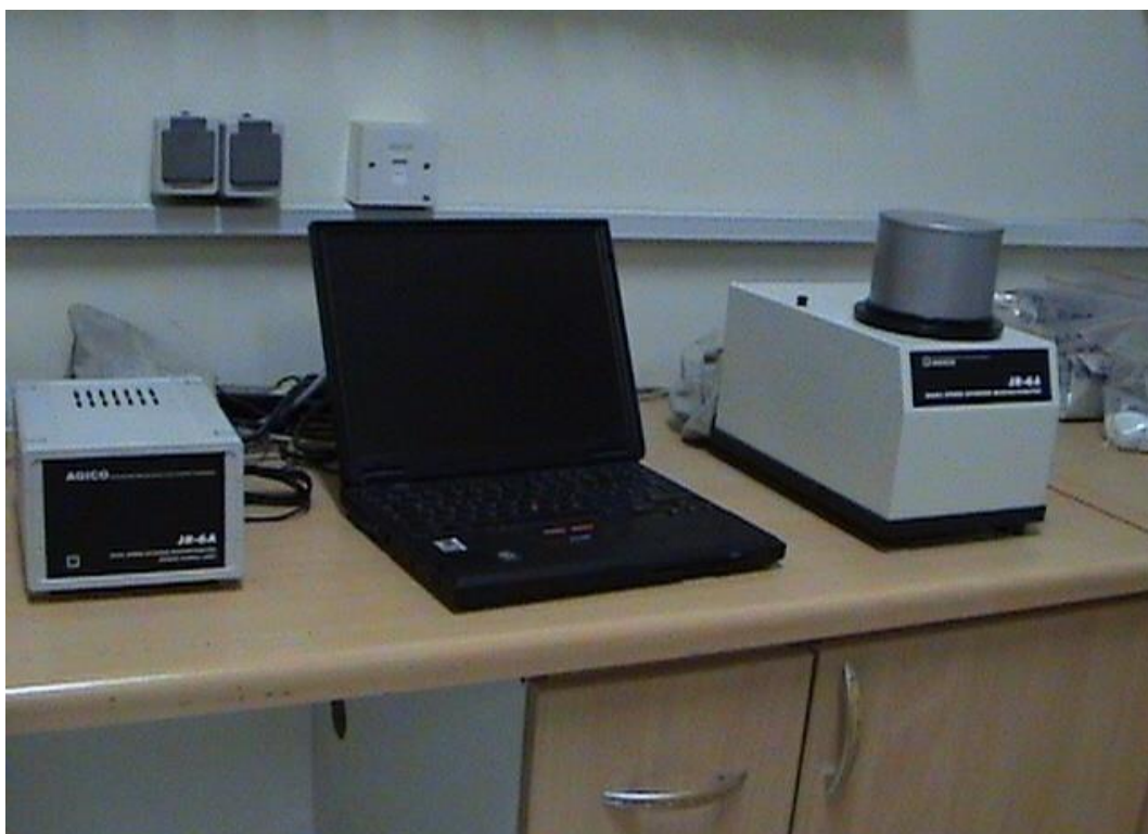
شکل ۶-۱۹- دستگاه اسپینر که برای اندازه‌گیری مقدار مغناطیس شدگی نمونه‌های دیرینه مغناطیسی و تعیین جهت‌های NRM از آن استفاده می‌شود.
