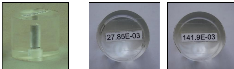
شکل ۴-۲۶- تصاویری از نمونه استاندارد جهت کالیبراسیون دستگاه. این تصاویر بخش بالایی، پایینی و نمونه استاندارد یا نمونه کالیبراسیون را نشان می‌دهد.
