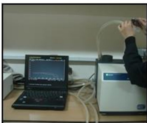
شکل ۶-۳۲- تصویر نشان دهنده دستگاه CS-3 و نحوه قرار دادن نمونه در آن ( سازمان زمین شناسی و اکتشافات معدنی کشور).
