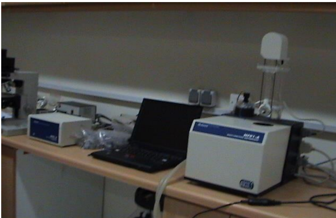
شکل ۶-۲۲- دستگاه Kappabridge مدل MFK-1 ساخت کارخانه AGICO که دستگاه Cs-3 بر روی آن نصب است و برای تعیین نوع کانی فرومگناطیس بکار می‌رود.
