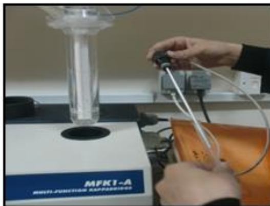
شکل ۶-۳۲- تصویر نشان دهنده دستگاه CS-3 و نحوه قرار دادن نمونه در آن ( سازمان زمین شناسی و اکتشافات معدنی کشور).
