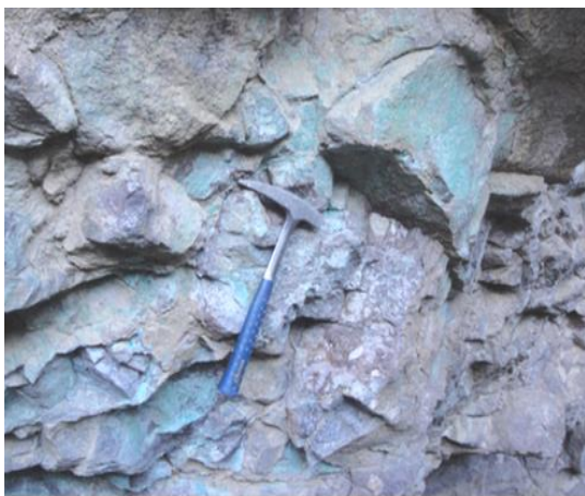
شکل ۲-۶۳ - تصویری از کانه زائی مس به صورت کالکوسیت و مالاکیت در محدوده معدن روگرو.
