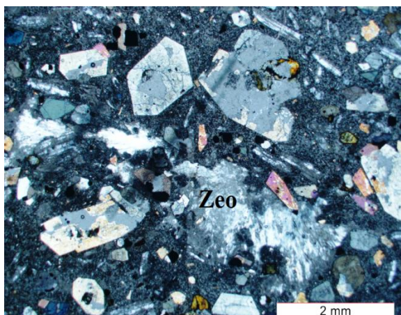
شکل ۳-۲۷- تصویری از حضور زئولیت با ساختار شعاعی در تراکی بازالت‌های حاوی پلاژیوکلاز قابل توجه. (XPL)
