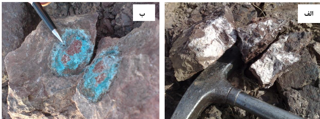
شکل ۳-۱۰: نمایی از وجود باریت همراه رگه‌های بلوک شمال چهارسنگ (الف)، نمایی از کانی‌سازی مالاکیت با ساخت کروی در بلوک شمال چهارسنگ (ب) (هدایتی روشن، ۱۳۸۸)
