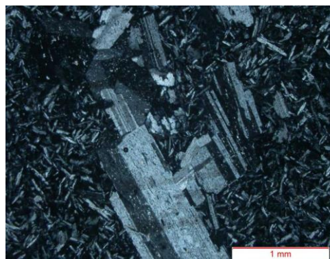
شکل ۳-۹- تصویری از ماکل کارلسباد و پلی سنتتیک در پلاژیوکلاز (نور XPL).
