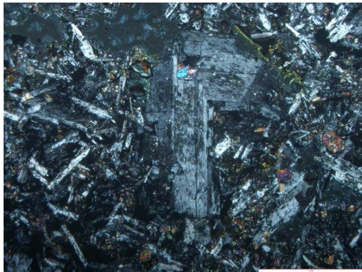
شکل ۳-۸- تصویری از بافت غربالی در پلاژیوکلازها (مقیاس ۱mm) (نور xpl)
