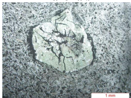
شکل ۳-۱۵- تصویری از درشت بلور کلینوپیروکسن که به کلریت تبدیل شده است. (نور PPL).
