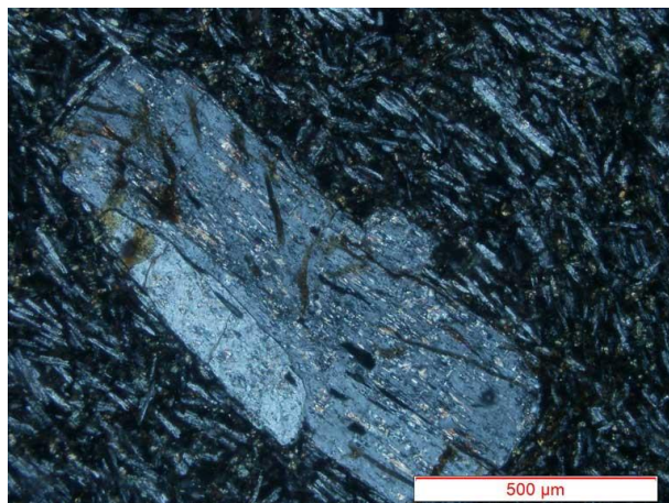
شکل ۳-۳۱- تصویری از دگرسانی درشت بلور پلاژیوکلاز به سریسیت (نور XPL).
