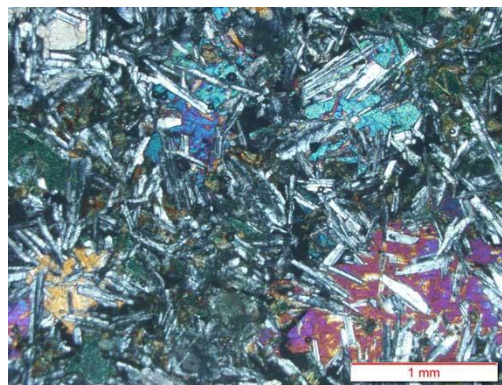
شکل ۳-۶- تصویری از بافت ساب افیتیک ناشی از قرارگیری بخشی از بلور پلاژیوکلاز درون کانی پیروکسن (نور XPL).
