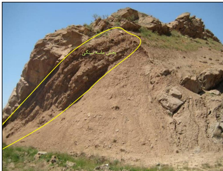
شکل (۴-۲۲)- واحد سنگی رسوبی تبخیری با شیب لایه بندی ۰۴۷،۶۰ (بخش ماسه سنگی GSI=60 ) جناح راست مخزن سد (نگاه به سمت شمال غرب)
