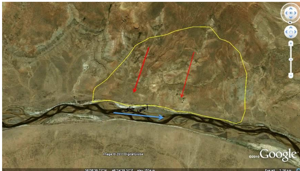
شکل (۴-۹) - زمین لغزش چرخشی شماره ۱۱، در مخزن سد ونیار
