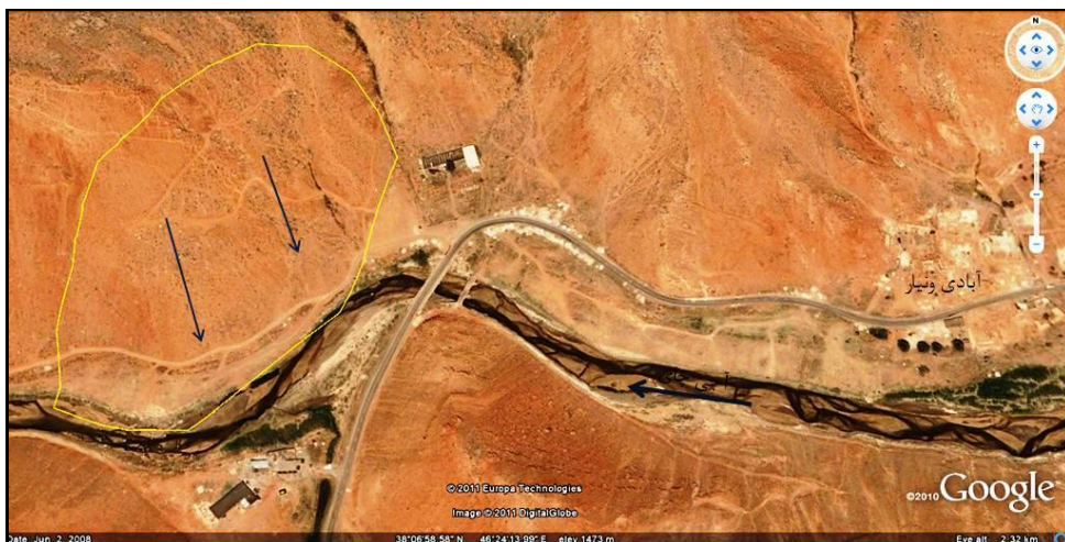
شکل (۴-۶) - زمین لغزش چرخشی شماره ۴، در اثر وقوع این زمین لغزش رودخانه به سمت جلو حرکت نموده است
