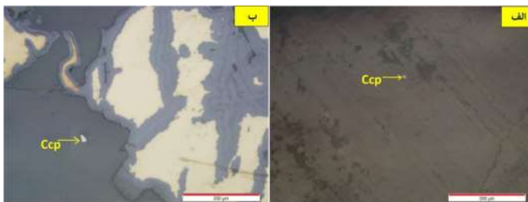
شکل ۶-۲۳- نمونه الف - AL-19 و ب- نمونه AL-17 که کالکوپیریت تشخیص داده شده است.
