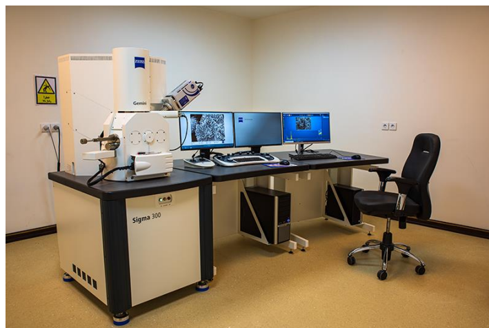
شکل ۵-۸ تصویری از دستگاه FESEM مدل Sigma 300- HV موجود در آزمایشگاه دانشگاه صنعتی شاهرود.
