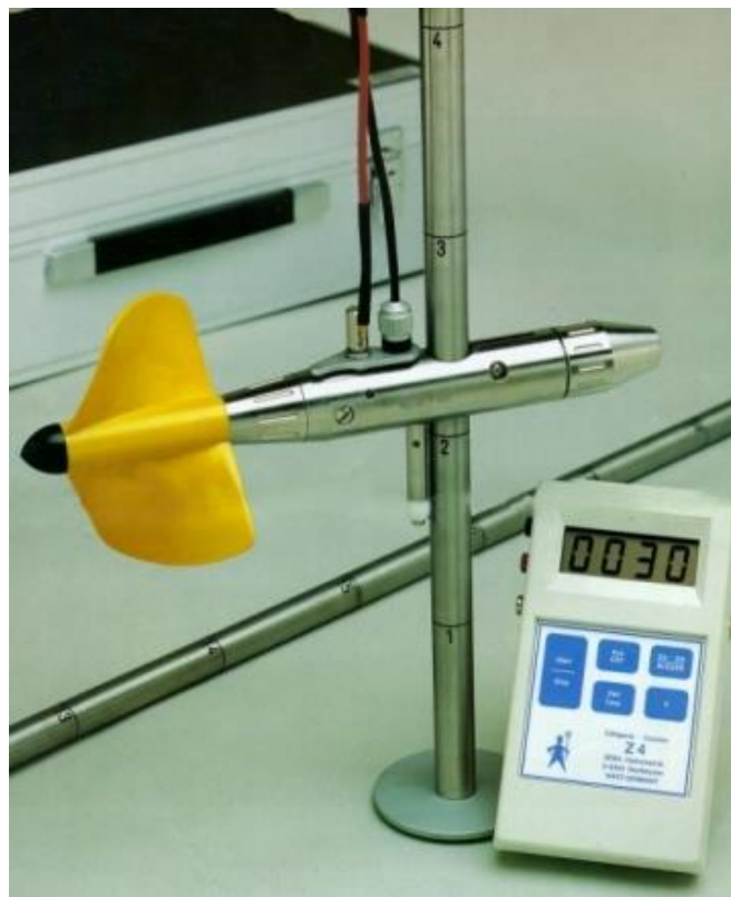
شکل ۳-۲ دستگاه مولینه جهت اندازه‌گیری سرعت جریان رودخانه
