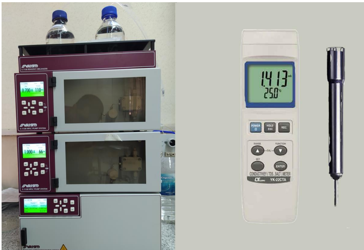
شکل ۳-۵ دستگاه اندازه گیری PH (راست) و گروماتوگرافی یونی (چپ)
